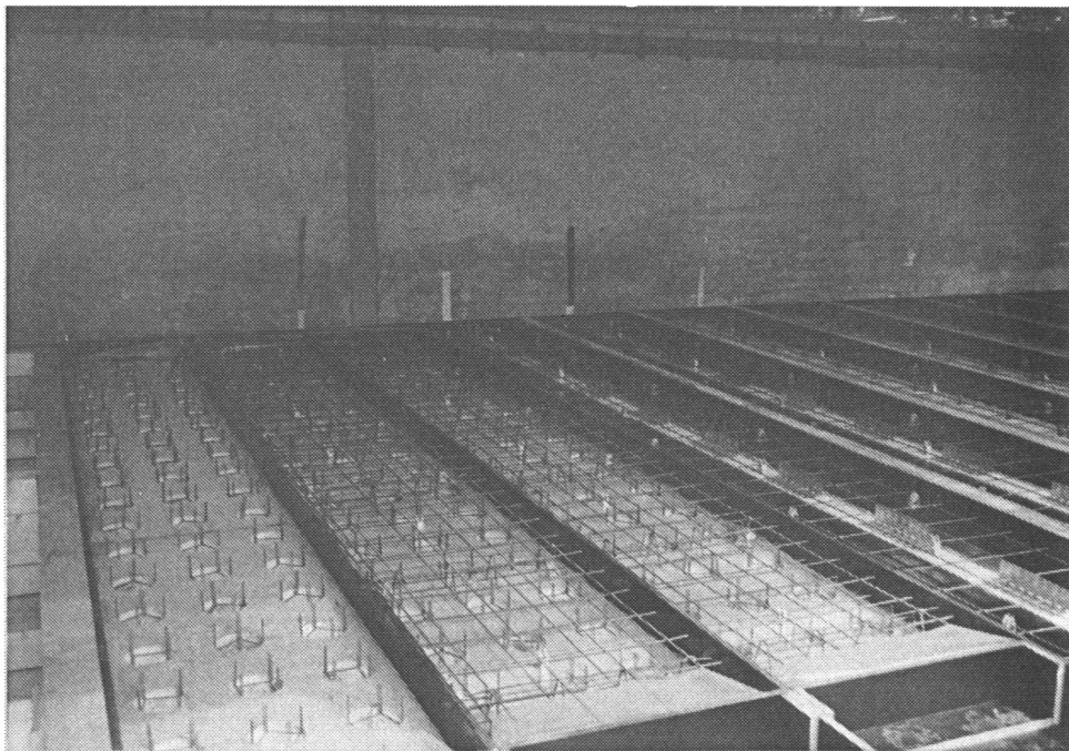
Abb. 64 Eingeschalte Prüfkörper vor dem Betonieren; rechts: Holzträger mit Nagelplatten, links: Furnierschichtholzplatten mit Ausfräsungen für Betonnocken und eingelegten Nockenbewehrungen.
