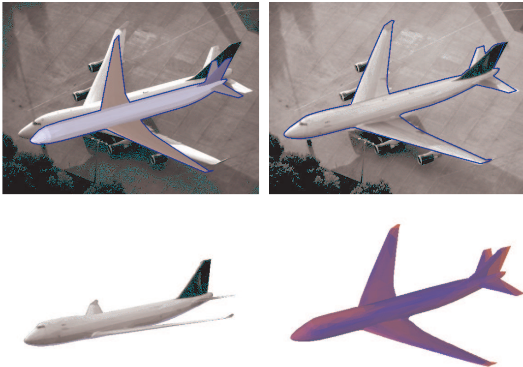
Abbildung 4.10: Rekonstruktion einer Boeing 747-400. Die initiale Lage sowie die initiale Modellausprägung (Airbus A340-300) sind links oben abgebildet. Rechts oben ist das Ergebnis der Modellanpassung zu sehen, wobei dem Modell die Textur des Bildes aufgeprägt wurde. In der zweiten Reihe ist links das Ergebnis der Rekonstruktion in einer anderen Lage zu sehen und rechts sind die Komponenten der Hausdorff-Distanz gegenüber der in der Datenbank abgelegten Boeing 747-400 farblich codiert. Dabei sind Dreiecke mit geringem Fehler blau und Dreiecke mit großem Fehler rot dargestellt.
