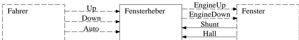
Bild 2-30: Activity-Chart einer Fensterhebersteuerung
