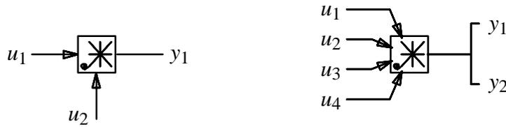
Bild 8-12: Product Block mit einem und zwei Ausgängen
