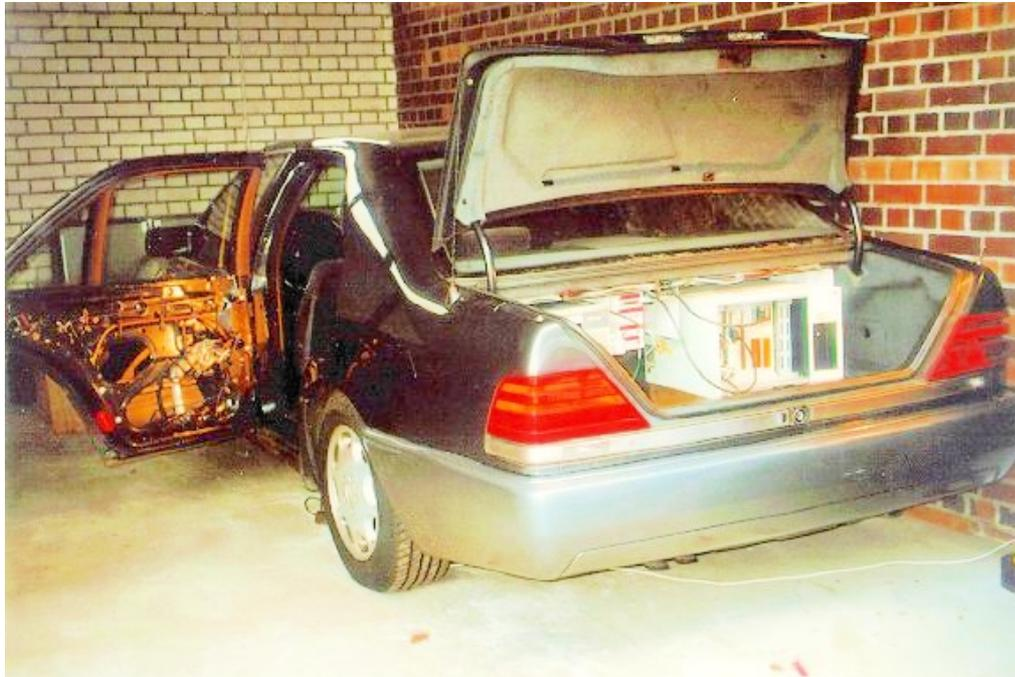
Bild 9-38: Rapid Prototyping einer Fensterheberansteuerung
