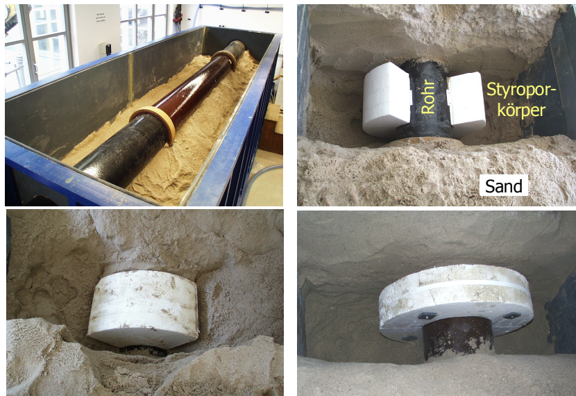
Abb. 5-3: Teststrecke im FZU mit Steinzeugrohr und verschiedenen Styroporkörpern zur Simulation der Hohlräume. oben links: Container mit Sandbettung und Steinzeugrohr oben rechts: Styroporkörper 270^\circ / 32 \text{ cm} unten links: Styroporkörper 90^\circ / 32 \text{ cm} im Scheitel unten rechts: Styroporkörper 360^\circ / 16 \text{ cm} .
