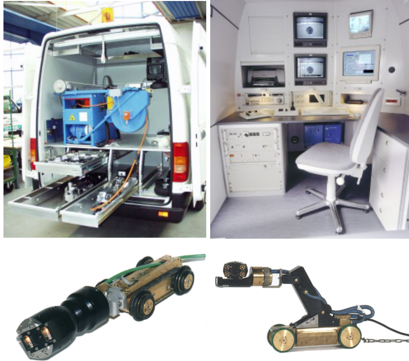
Abb. 1-1: Marktübliche TV-Kamerasysteme (Fotos von IBAK-Kiel und JT-elektronik-Lindau). Innenausbau der Fahrzeuge und zwei verschiedene TV-Kamerasysteme mit jeweiligem Kamerafahrwagen.
