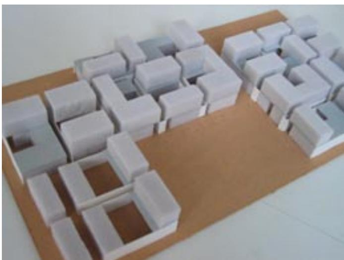
Um die konstruktive Unabhängigkeit des einzelnen Hauses zu gewährleisten und eine spätere Verlegung der Infrastruktur zu ermöglichen, werden zwischen den Parzellen begehbare Fugen freigehalten.
