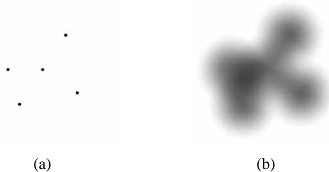
Abbildung 3: (a) Bei herkömmlichen Partikelsystemen ist eine Teilcheneigenschaft (z. B. die Masse) meist in einem Punkt konzentriert. (b) Bei SPH wird die Teilcheneigenschaft über den Raum „verschmiert“.
