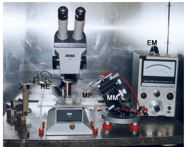
Abb. 9: Anordnung zur Messung der Membranspannung
