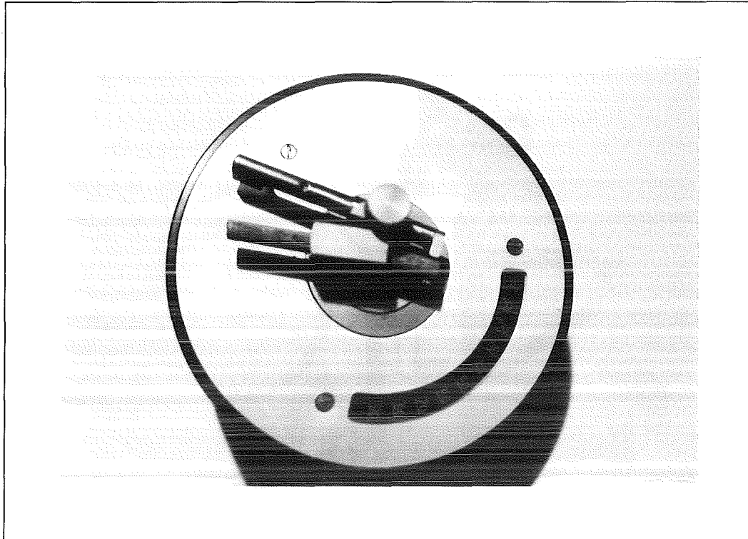
Abbildung 19: Fractometer I zur Ermittlung der Querfestigkeit und der Steifigkeit von Hölzern anhand von Bohrkernen.
