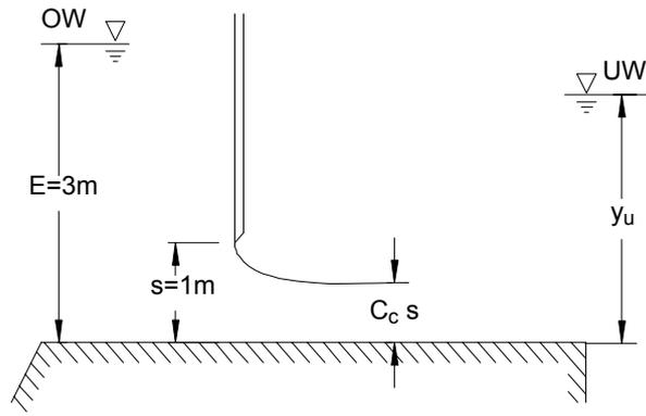
Abb. 10.3 b: Rechteckgerinne mit Schütz und Unterwasserstauhöhe  $y_U = y_2$
