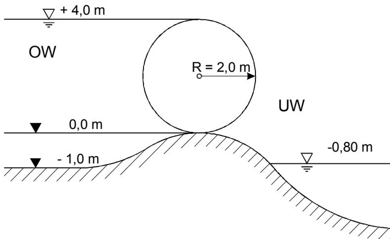
Abb. 2.7.3: Seitenansicht des zylinderförmigen Verschlusses (Breite  $B = 10 \text{ m}$ )
