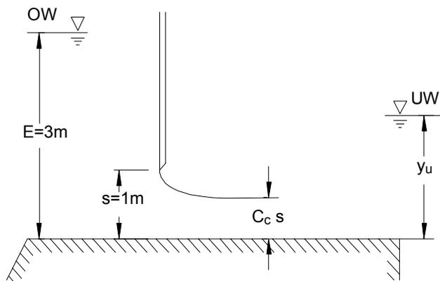
**Abb. 10.3 a:** Rechteckgerinne mit Schütz und Unterwasserstauhöhe  $y_U < y_2$
