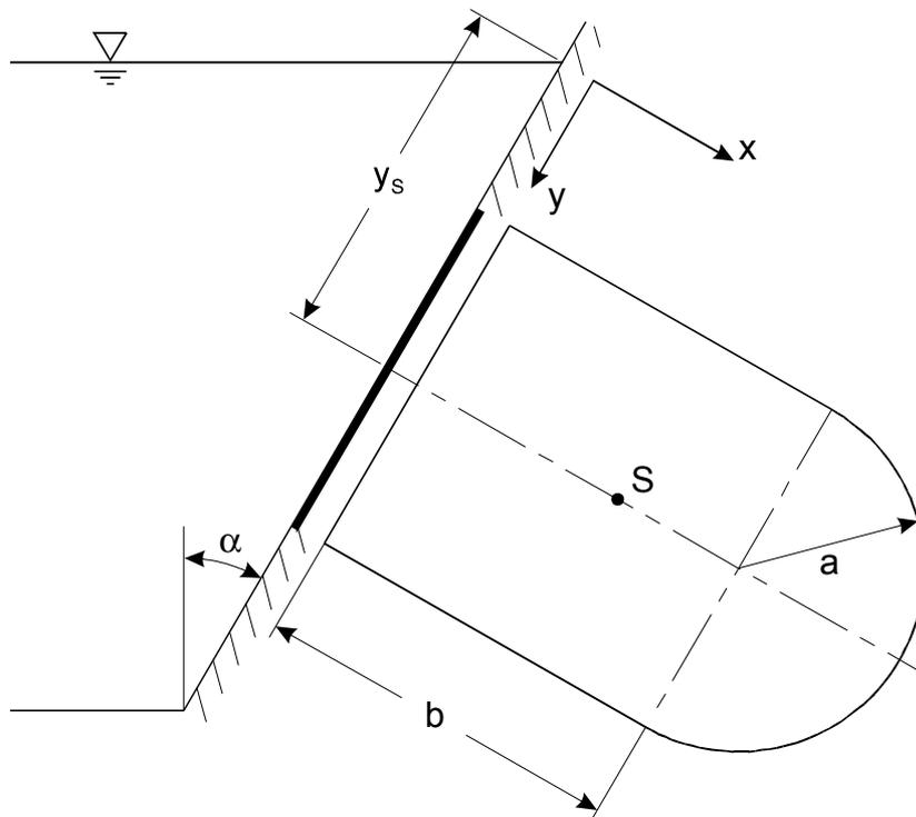
Abb. 2.6: Klappe in Seitenansicht und Draufsicht
