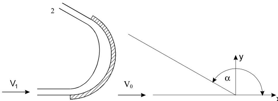
Abb. 4.7: Draufsicht auf die Turbinenschaufel
