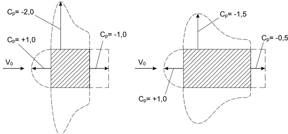
Abb. 9.1: Quer angeströmter Stab mit (a) quadratischem und (b) rechteckigem Querschnitt
