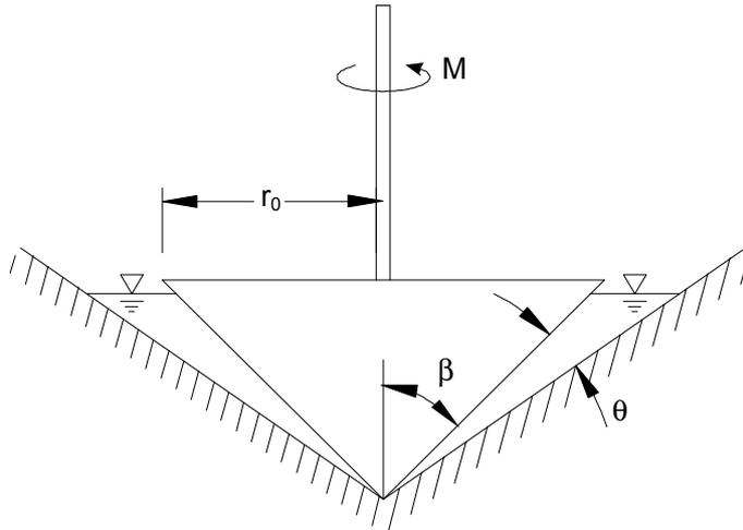
Abb. 7.3: Rotierender Kegel
