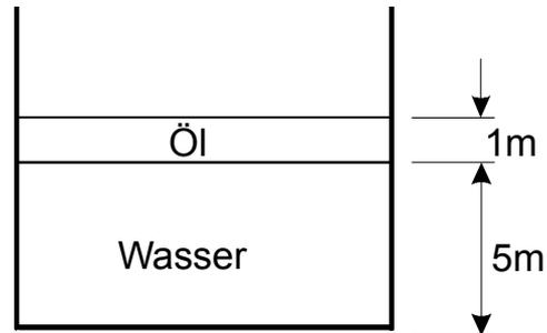
Abb. 2.10.2: Behälter mit zwei geschichteten Fluiden
