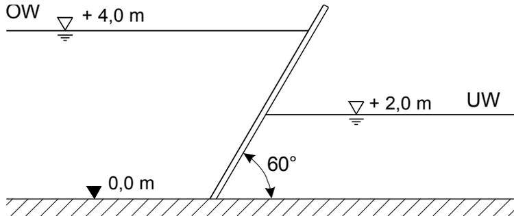
Abb. 2.2.1: Seitenansicht der geneigten Platte ( $B = 10 \text{ m}$ )
