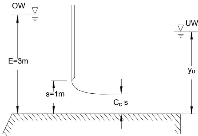
Abb. 10.3 c: Rechteckgerinne mit Schütz und Unterwasserstauhöhe  $y_U > y_2$
