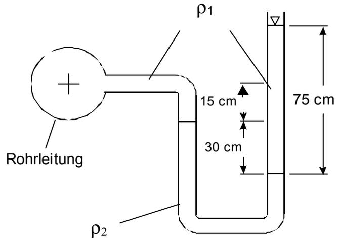
Abb. 2.8: Rohrleitung mit Manometer
