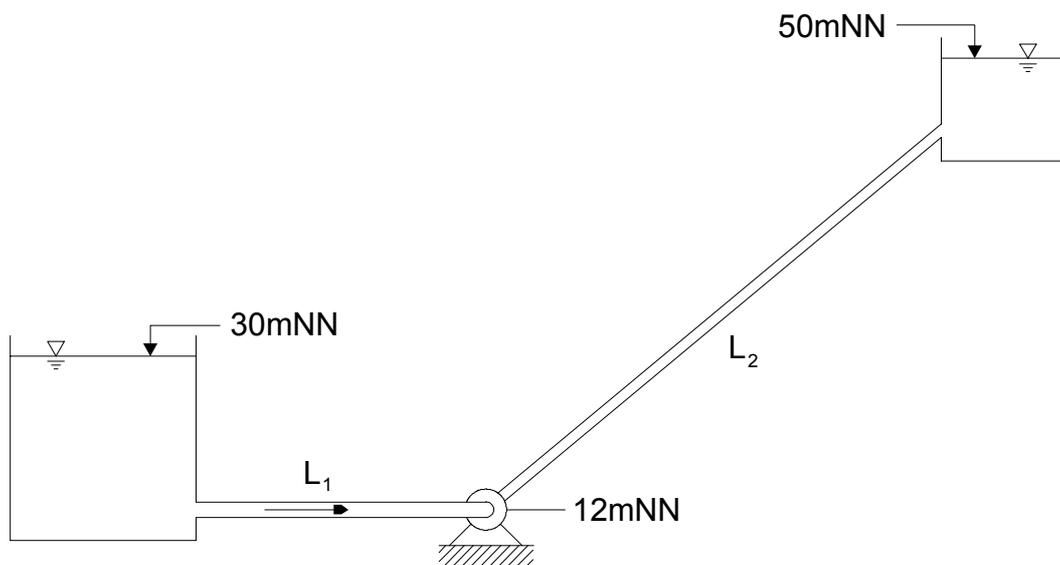
Abb. 5.10: Rohrleitungssystem zur Wasserversorgung
