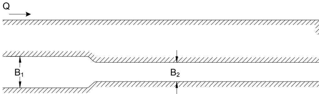
**Abb. 10.2 b:** Rechteckgerinne mit ebener Sohle und Einengung von der Breite  $B_1 = 3\text{ m}$  auf die Breite  $B_2 = 2\text{ m}$
