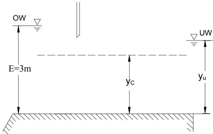
Abb. 10.3 e: Rechteckgerinne mit gezogenem Schütz und Unterwasserstauhöhe  $y_U > y_c$
