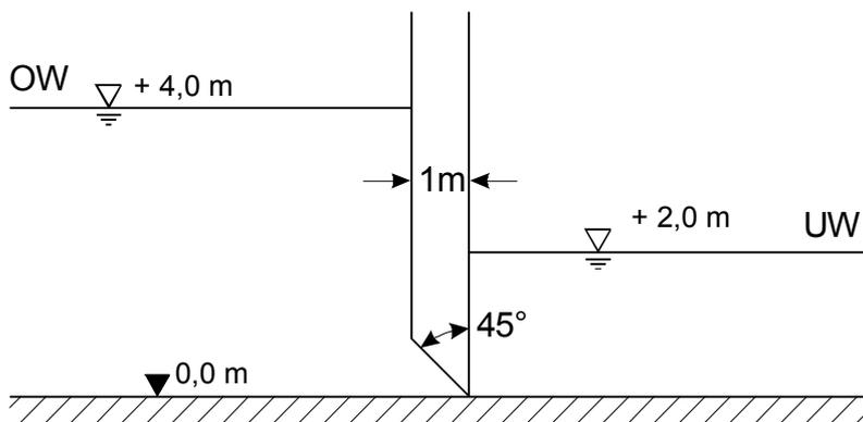
Abb. 2.7.2: Seitenansicht der vertikalen Platte (Breite  $B = 10 \text{ m}$ )
