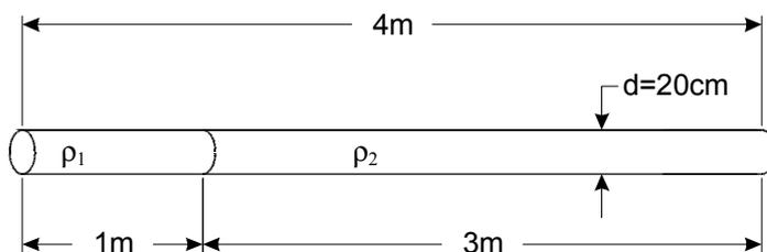
Abb. 2.10.1: Vollzylinder aus zwei verschiedenen Materialien
