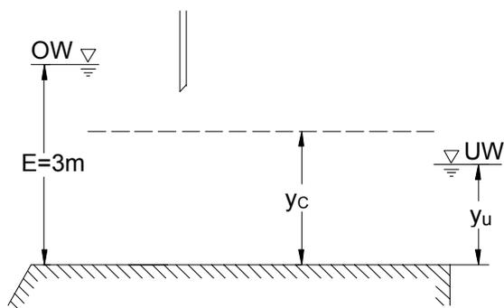
Abb. 10.3 d: Rechteckgerinne mit gezogenem Schütz und Unterwasserstauhöhe  $y_U < y_c$
