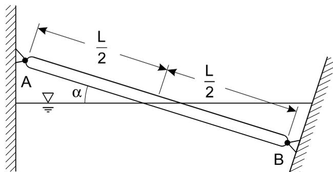
Abb. 2.11: Behälter mit schwimmendem Balken
