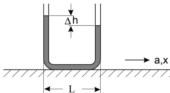
Abb. 4.3: Beschleunigungsmesser auf einem Fahrzeug
