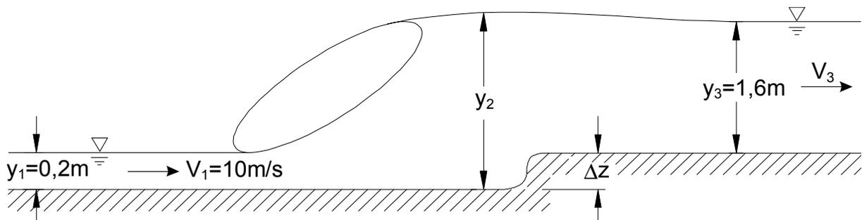
Abb. 10.1: Wechselsprung an einer Sohlschwelle im Rechteckgerinne
