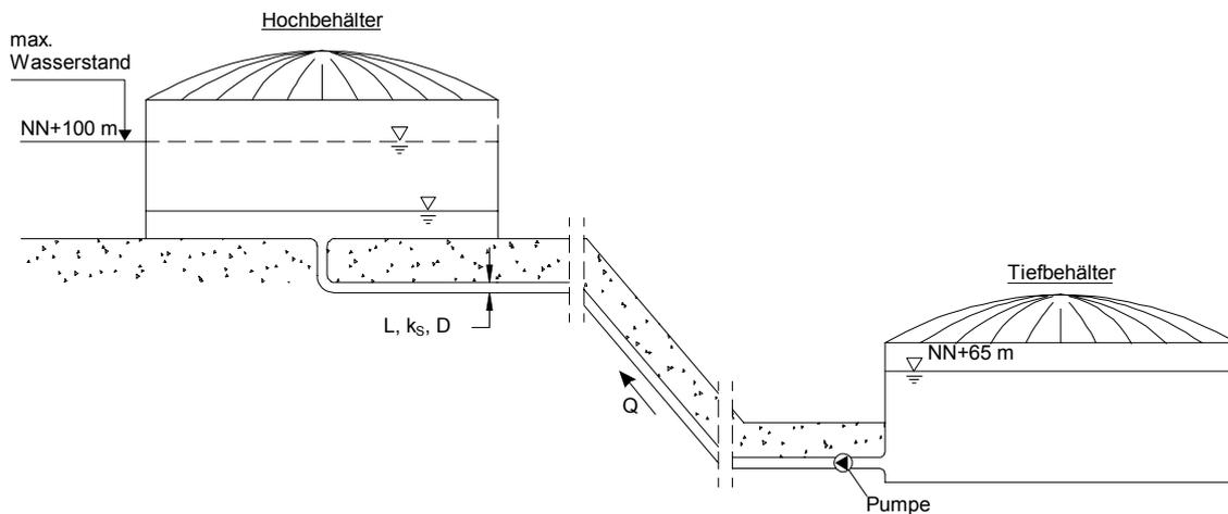
Abb. 8.1: Wasserleitung zwischen Hoch- und Tiefbehälter
