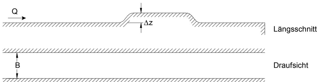
Abb. 10.2 a: Rechteckgerinne konstanter Breite  $B = 3 \text{ m}$  mit Schwelle der Höhe  $\Delta z = 0,5 \text{ m}$
