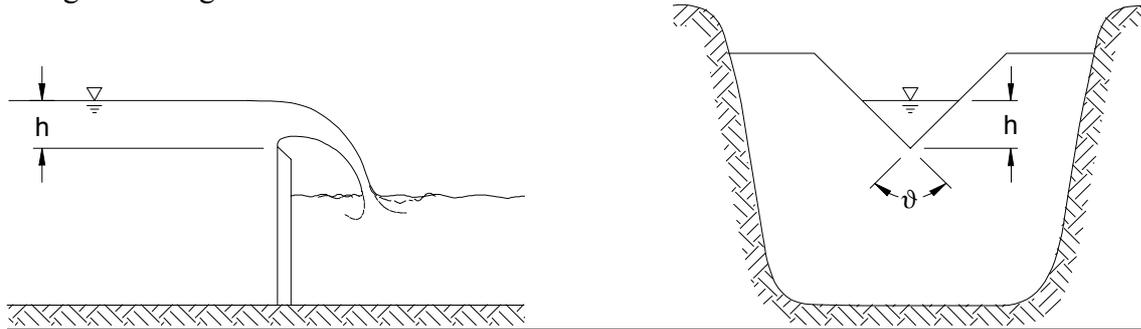
Abb. 6.3: Dreieckswehr in Seitenansicht (a) und im Querschnitt (b)
