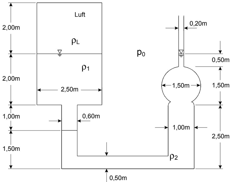
Abb. 2.5: Luftbehälter mit Steigrohr
