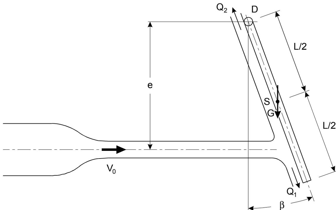
Abb. 4.8: Angeströmte Platte
