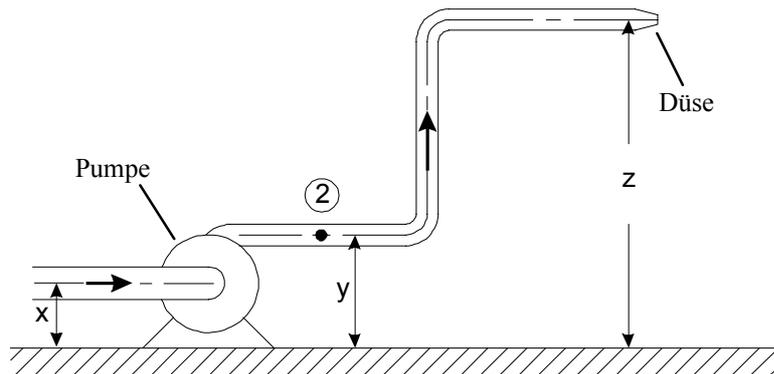
Abb. 5.7: Rohrleitung mit Pumpe
