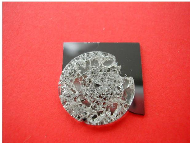
Abbildung 8.2: Beispiel für das Verkleben zwischen Glas und Schichtmaterial (BP3 1924). Das Glas (FK90, Durchmesser etwa 10 mm) klebt auf dem beschichteten Substrat und weist Risse und Ausbrüche auf.
