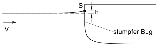
Abb. 4.9: Bugwelle durch die Relativgeschwindigkeit eines Schiffes
