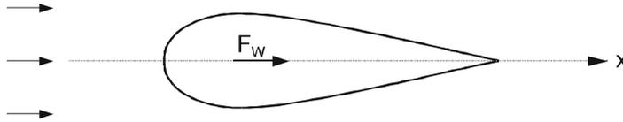
Abb. 9.2: Widerstand bei Umströmung eines symmetrischen Körpers
