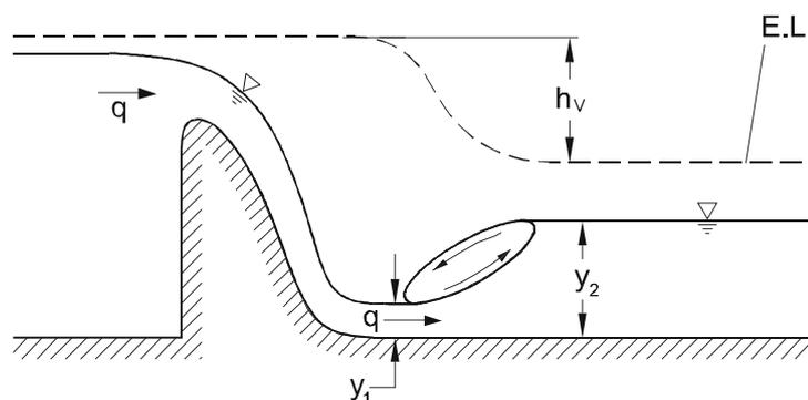
Abb. 10.17: Wechselsprung am Fuße eines Wehres
