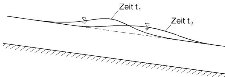
Abb. 10.7: Instationäre Gerinneströmung
