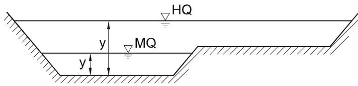
Abb. 10.4: Verbundprofil bestehend aus Hauptgerinne (bei Niedrig- bis Mittelwasserabflüssen) und Überschwemmungsgerinne (bei Hochwasserabflüssen)
