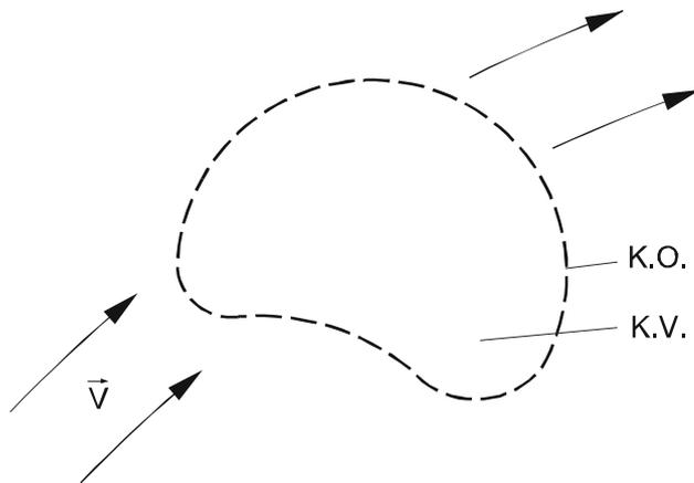
Abb. 3.14: Kontrollvolumen und Kontrolloberfläche im Geschwindigkeitsfeld  $\vec{V}$
