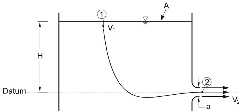
Abb. 4.6: Ausfluß aus einem Behälter
