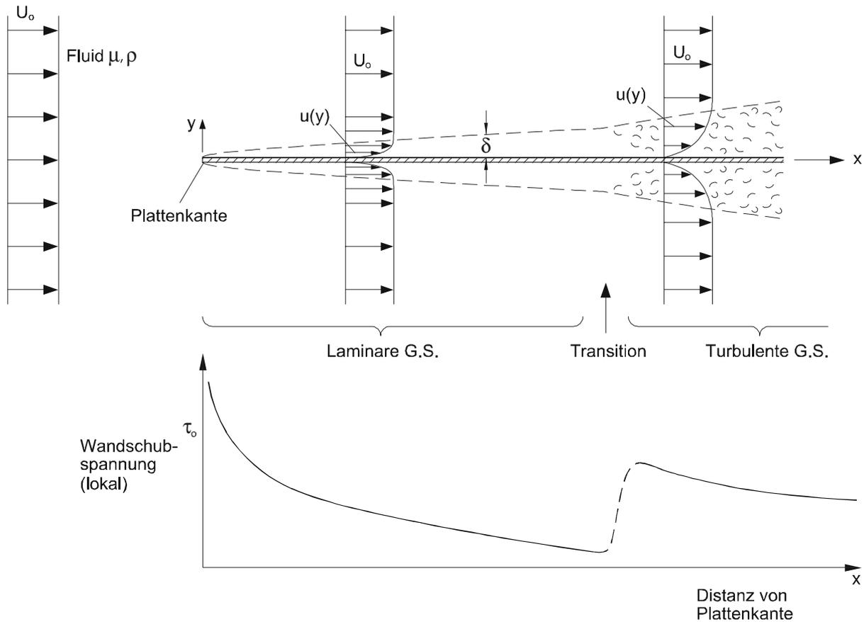
Abb. 7.5: Grenzschichtverhalten entlang einer dünnen Platte ohne Druckgradienten,  $dp/dx = 0$ .
