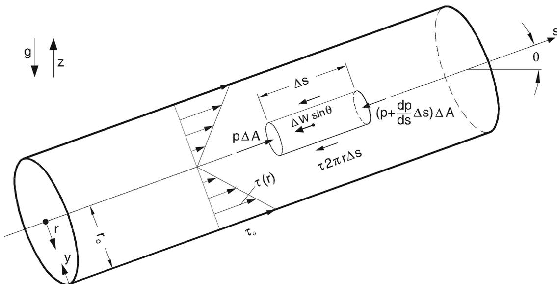
Abb. 8.1: Strömung in einem Kreisrohr mit Schubspannungsverteilung
