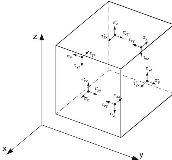
Abb. 4.30: Oberflächenspannungen im differentiellen K.V.
