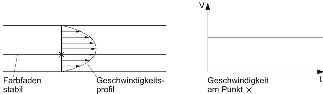
Abb. 3.9: Beobachtungen in einer laminaren Rohrströmung
