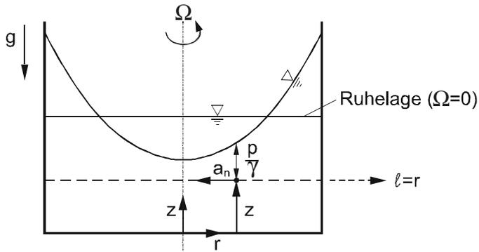
Abb. 4.3: Festkörperwirbel im rotierenden Tank
