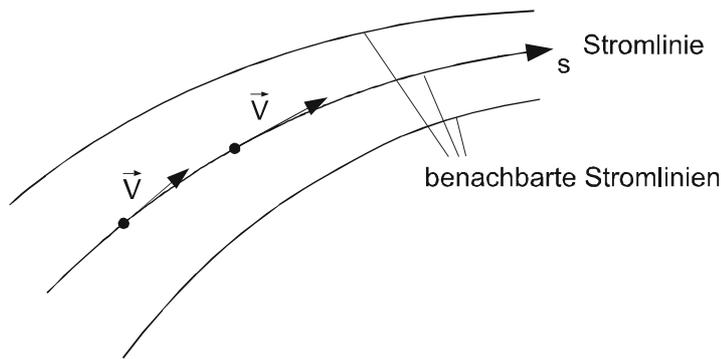
Abb. 3.3: Strömungsbild mit Hilfe von Stromlinien zur Zeit  $t$
