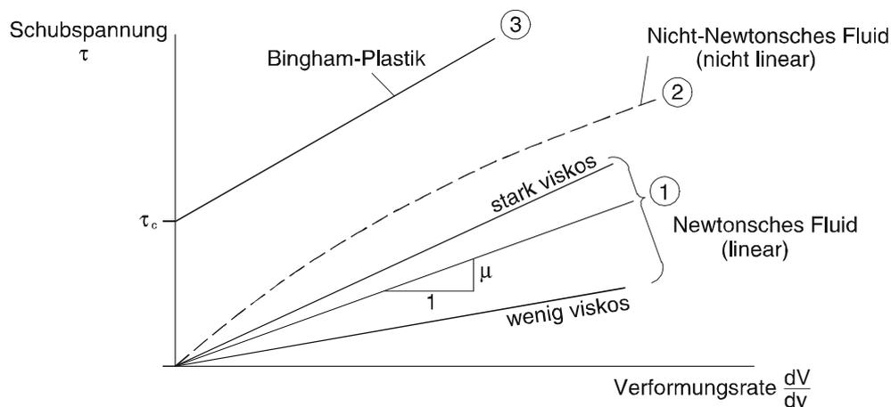
Abb. 1.7: Rheologisches Diagramm für diverse Fluide
