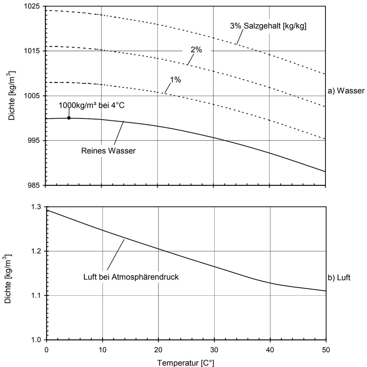
Abb. 1.2: Dichte von Wasser und Luft in Abhängigkeit von der Temperatur
