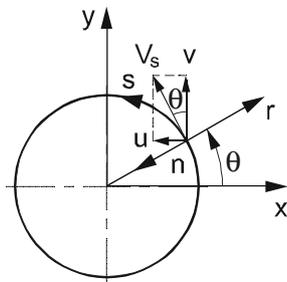
Abb. 4.4: Stationäre Bewegung entlang konzentrischen Kreisbahnen. Beziehung zwischen Geschwindigkeiten im kartesischen  $(x, y)$ , zylindrischen  $(r, \theta)$  und natürlichen  $(s, n)$  Koordinatensystem.
