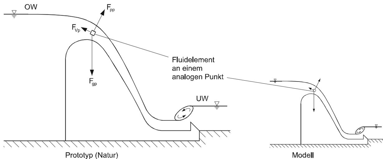
Abb. 6.5: Wehrüberströmung in Natur (Prototyp) und Modell
