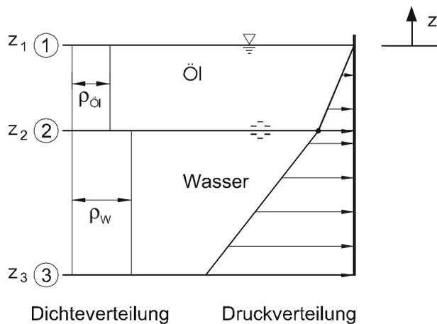
Abb. 2.9: Druckverteilung an Behälterwand bei diskret geschichteten Fluiden
