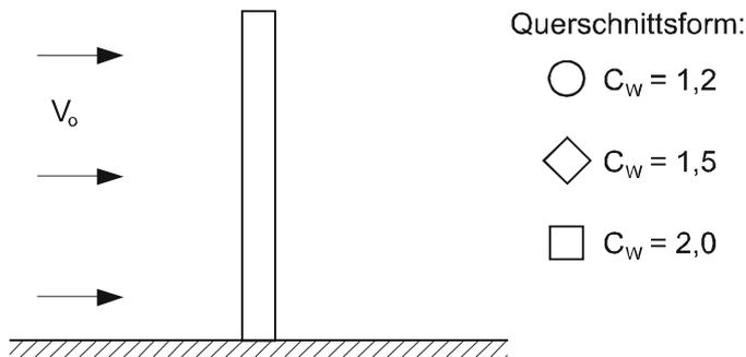
Abb. 9.13: Windkraft auf ein Einzelgebäude (z.B. Turm oder Schornstein)
