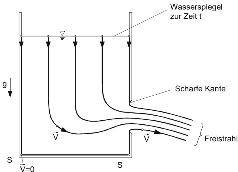
Abb. 3.4: Strömungsbild beim Ausfließen einer Flüssigkeit aus einem Gefäß
