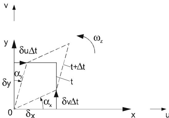
Abb. 3.18: Zeitliche Änderung eines zweidimensionalen Fluidelementes unter Einwirkung von Rotation und Winkeldeformation
