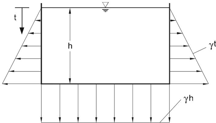
Abb. 2.8: Druckverteilung an Behälterberandung
