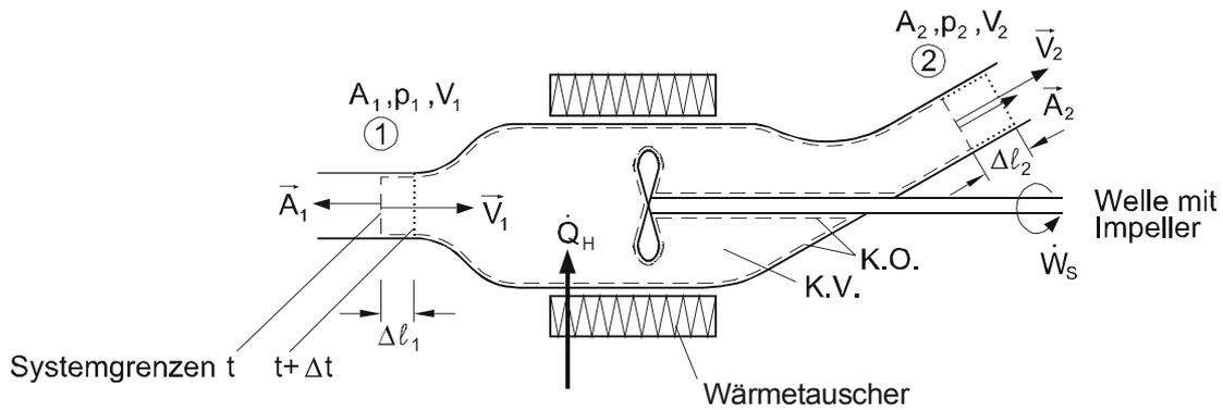
Abb. 5.1: Generelle Fluidmaschine mit Wärmezufuhr und Arbeitsleistung
