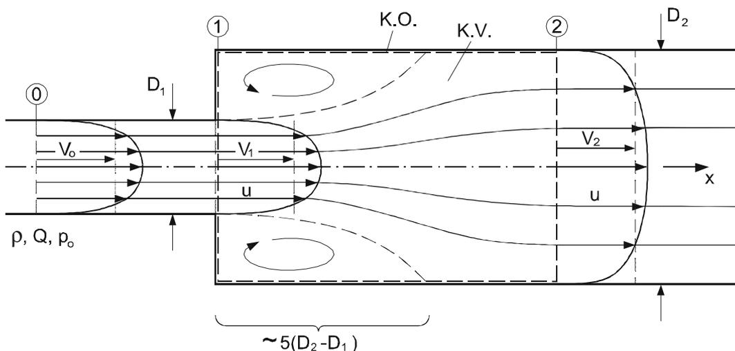
Abb. 5.5: Plötzliche Rohrerweiterung mit Rückströmzone
