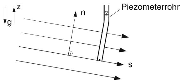
Abb. 4.7: Parallele Strömung im Schwerfeld
