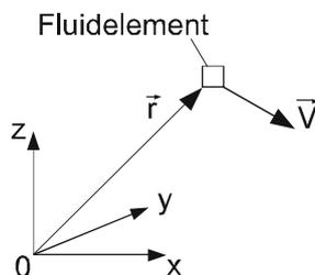
Abb. 4.32: Drehimpuls eines Fluidteilchens um den Ursprung
