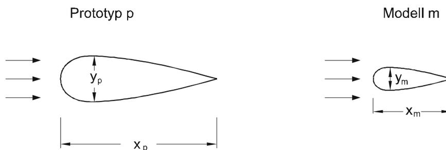
Abb. 6.4: Umströmung eines Brückenpfeilers in Natur und Modell (Grundriß)
