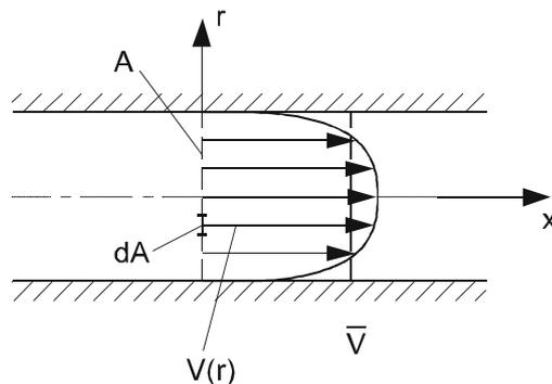
Abb. 4.20: Auswertung des Impulsflusses für eine Rohrströmung
