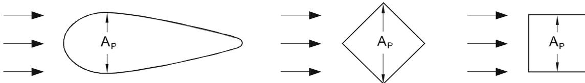
Abb. 9.4: Beispiele zur Definition der Querschnittsfläche bei Körperumströmung
