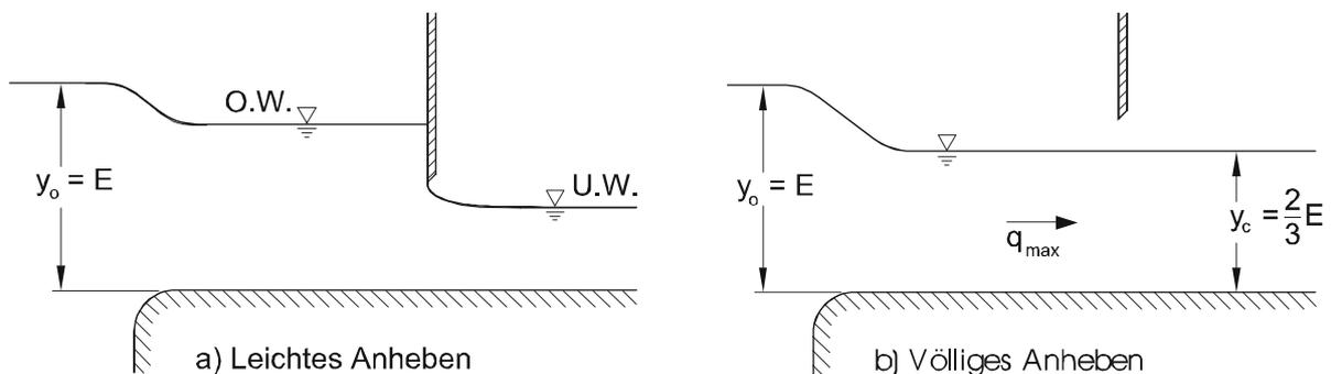
Abb. 10.13: Wasserspiegelverlauf nach Anheben des Schützes
