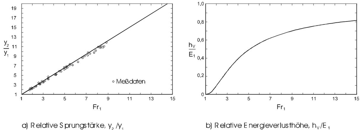
Abb. 10.19: Wechselsprung als Funktion der Froudezahl  $Fr_1$
