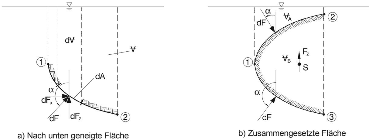
Abb. 2.15: Willkürliche Anordnung von gekrümmten Flächen im hydrostatischen Druckfeld
