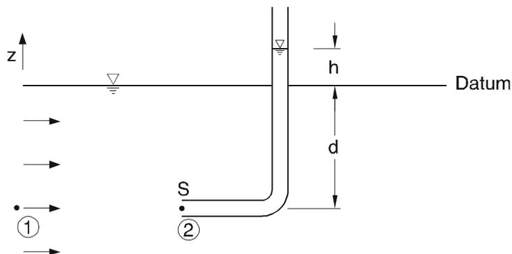
Abb. 4.8: Pitot-Rohr
