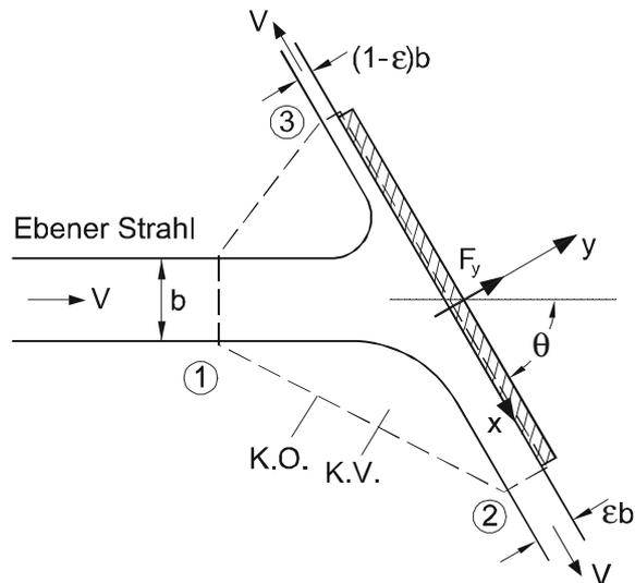
Abb. 4.24: Ebene Ablenkplatte mit Aufspaltung eines Freistrahles
