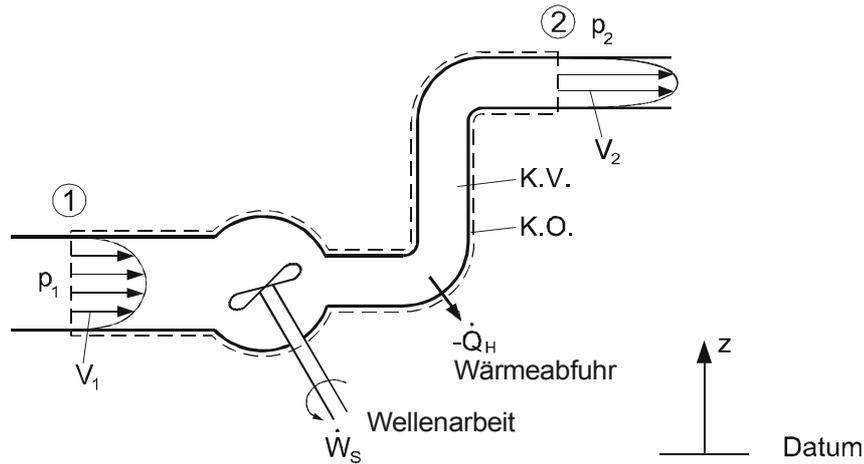
Abb. 5.2: Rohrleitungsabschnitt mit Fluidmaschine
