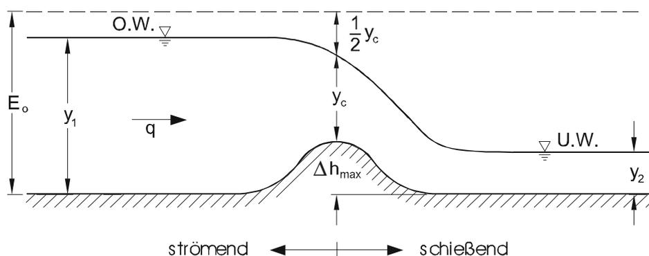
Abb. 10.15: Energiehöhen bei Abfluß über eine Sohlschwelle
