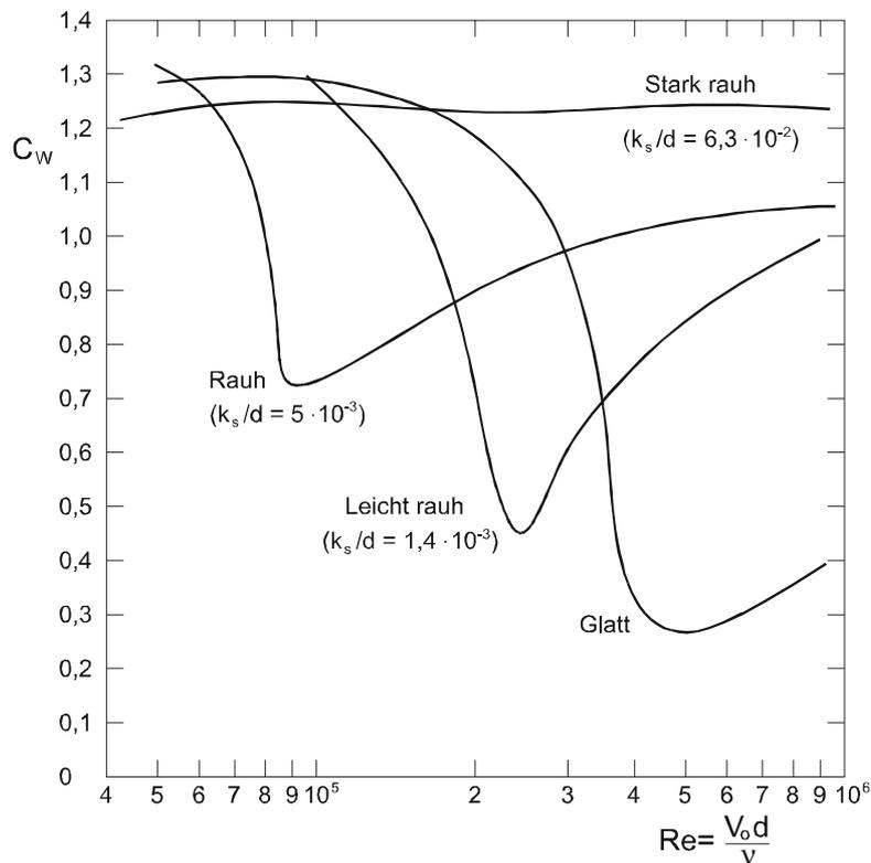
Abb. 9.7: Einfluß der Rauheit  $k_s/d$  auf den Widerstandsbeiwert  $C_W$  des Kreiszylinders aufgrund der Transition zur turbulenten G.S. (nach Roberson und Crowe, 1993)
