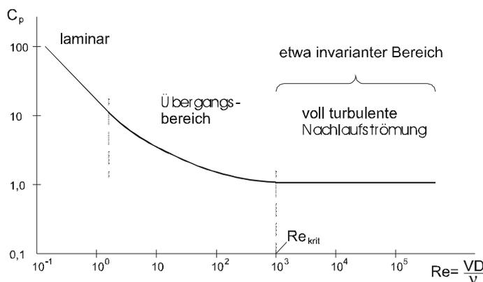
Abb. 6.7: Druckkoeffizient bei Umströmung eines Körpers mit etwa invariantem Bereich bei hohen Reynoldszahlen
