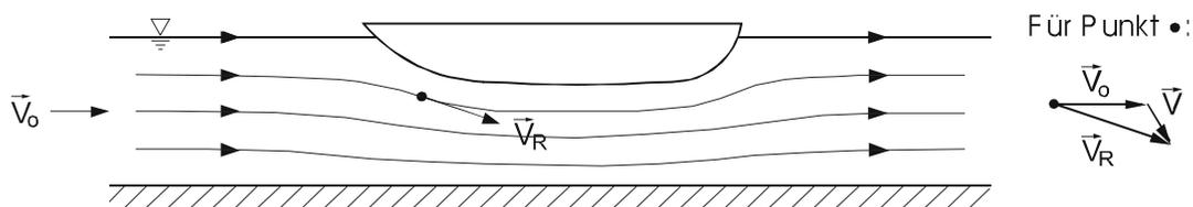
Abb. 3.7: Stationäres Stromlinienbild für Relativbewegung: Beispiel eines Bootes in einem Kanal
