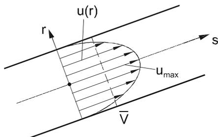
Abb. 8.3: Parabolische Geschwindigkeitsverteilung in laminarer Rohrströmung
