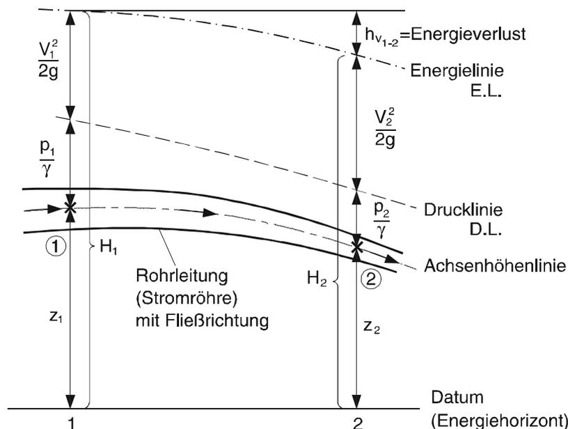
Abb. 5.3: Energie- und Drucklinie in einem hydraulischen System
