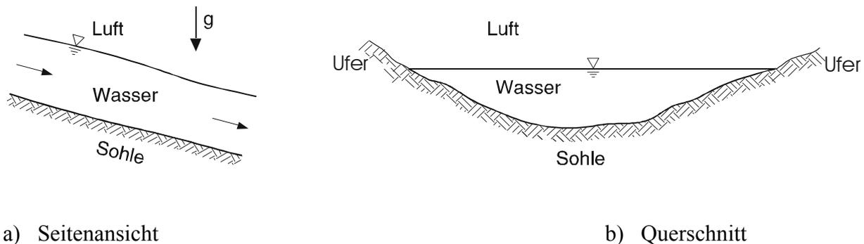
Abb. 10.1: Gerinneströmung mit freier Wasseroberfläche
