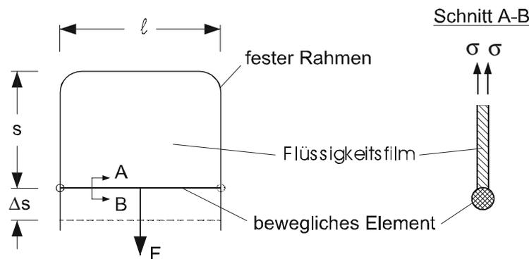
Abb. 1.10: Einrichtung zur Messung der Oberflächenspannung
