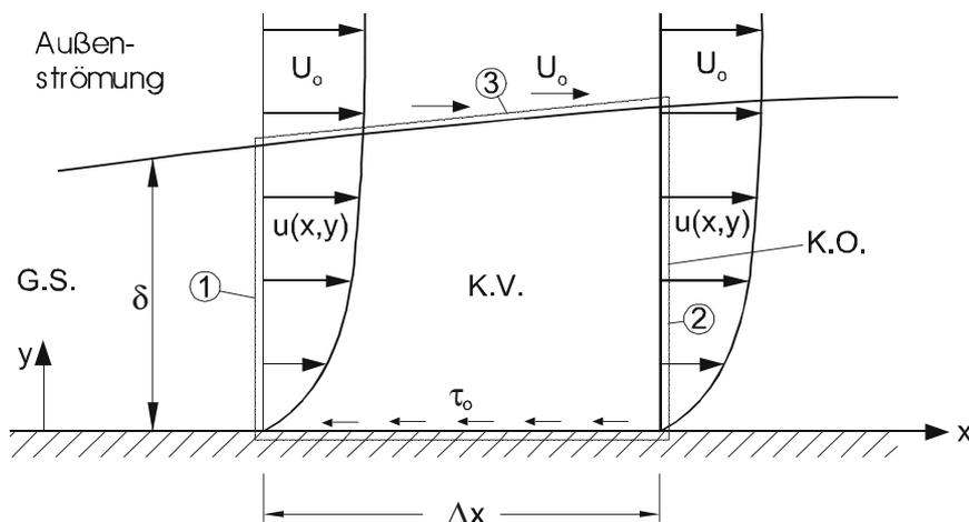
Abb. 7.10: Kontrollvolumen zur Impulsbetrachtung in der turbulenten Grenzschicht
