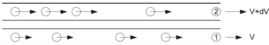
Abb. 1.5: Transportbandanalogie zum molekularen Impulsaustausch
