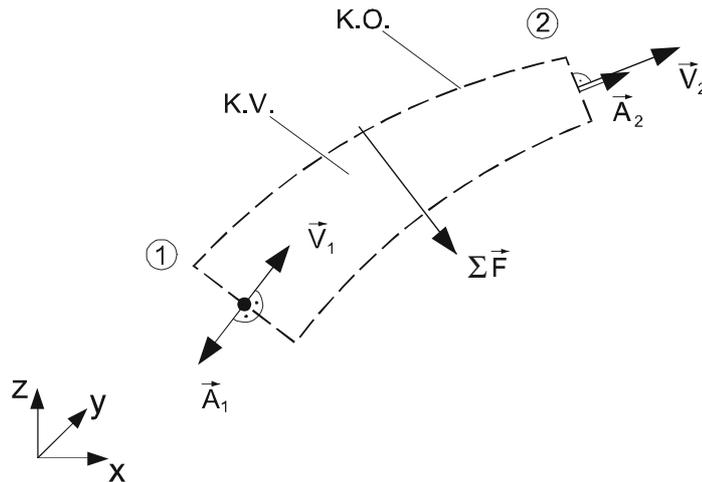
Abb. 4.19: Finites Kontrollvolumen (Beispiel einer Stromröhre)
