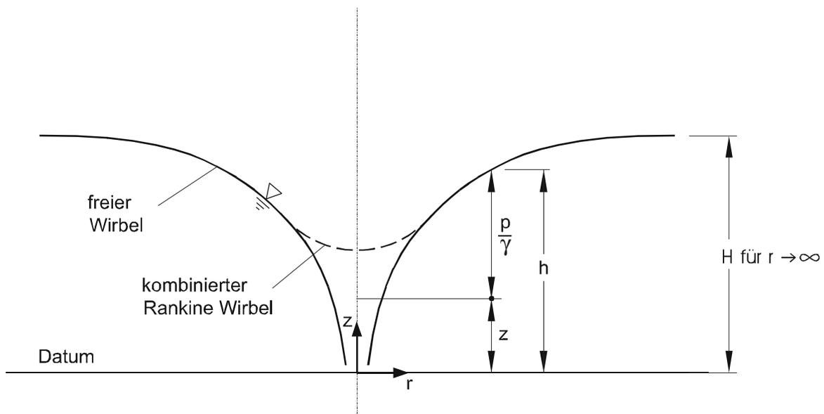
Abb. 4.12: Längsschnitt durch einen freien Wirbel
