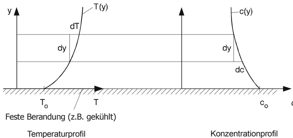
Abb. 1.8: Temperatur- und Konzentrationsverteilung in einem Fluid
