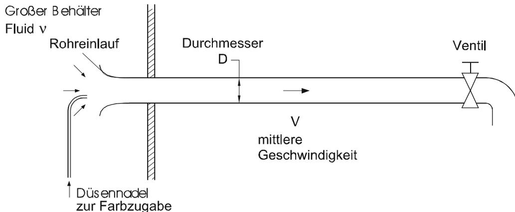
Abb. 3.8: Versuchsanordnung zur Rohrströmung nach O. Reynolds (1883)
