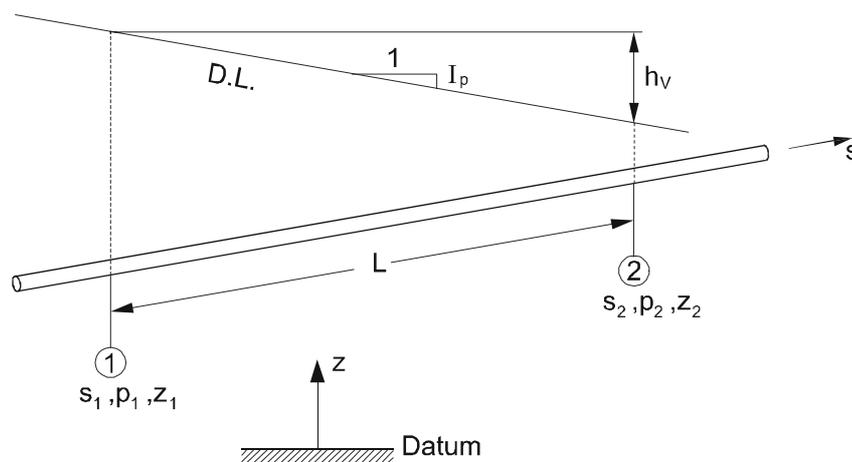
Abb. 8.2: Energieverlust bei gleichförmiger Strömung in einem Rohrschnitt
