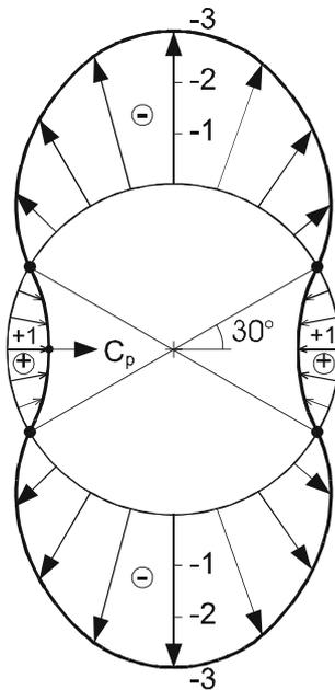
Abb. 4.14: Druckverteilung an der Zylinderperipherie bei idealer Strömung
