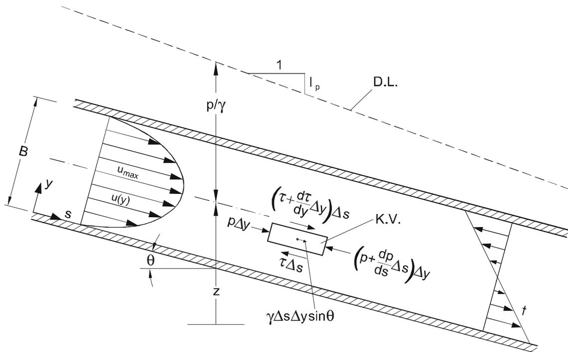
Abb. 7.3: Ebene Poiseuille-Strömung
