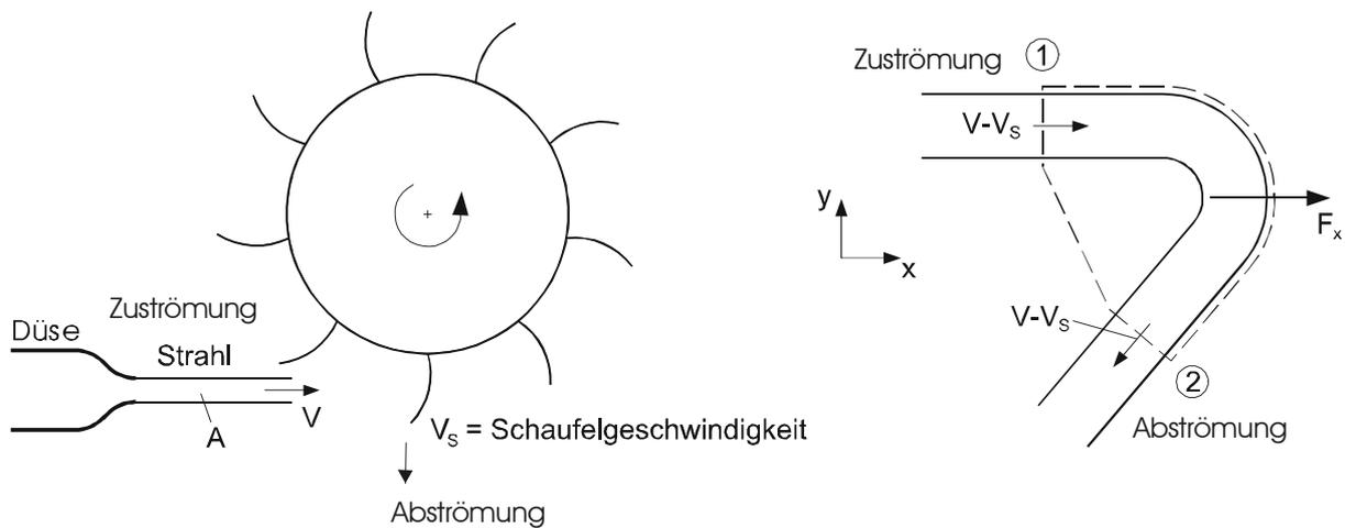
a) Anwendung bei einer Pelton-turbine
