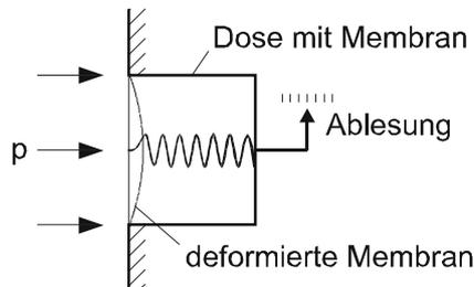
Abb. 2.11: Bourdon-Barometer
