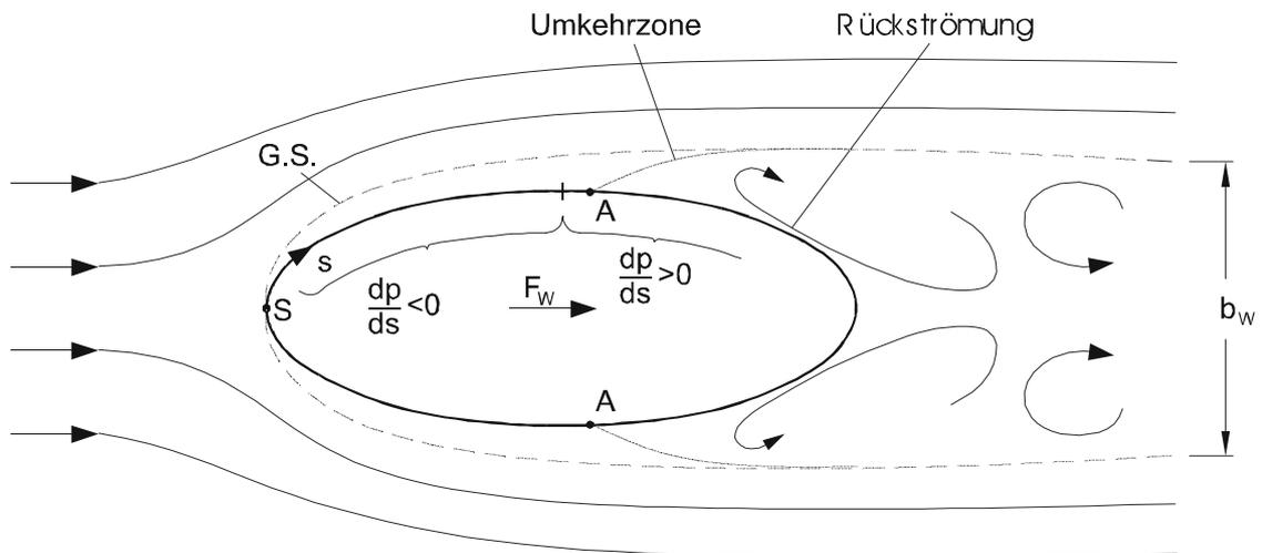
Abb. 9.3: Grenzschichtverhalten bei Umströmung eines gewölbten Körpers
