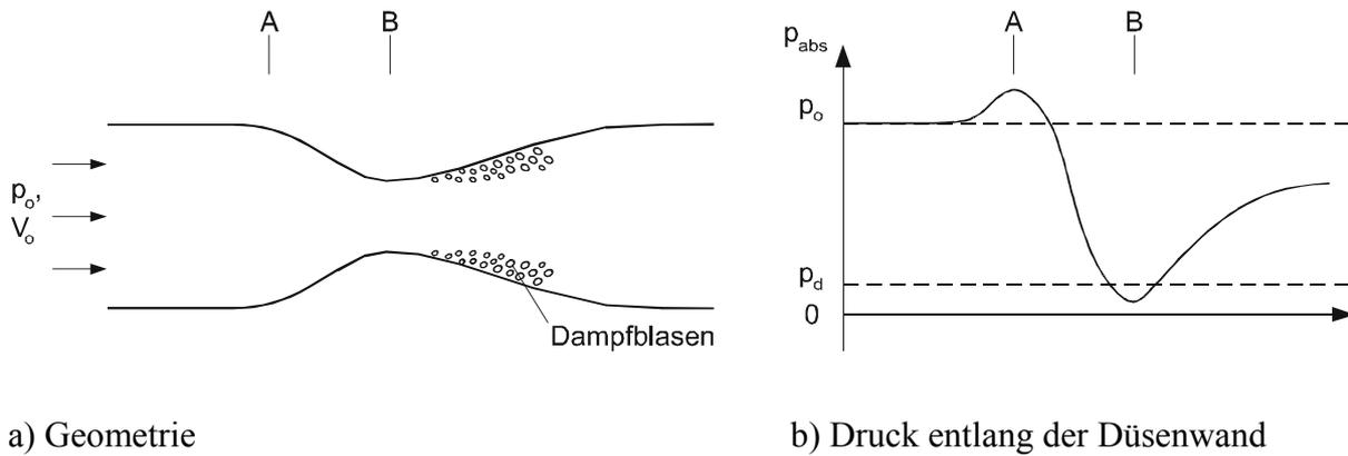
Abb. 4.18: Kavitation in einer Düse bestehend aus einer Verengung und allmählicher Erweiterung
