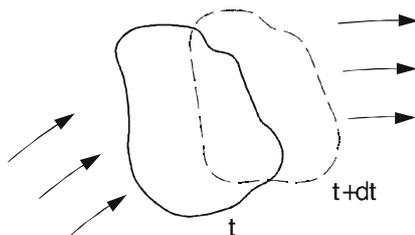
Abb. 1.1: Fluid als bewegtes und verformbares Massensystem
