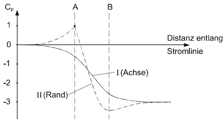
Abb. 4.11: Druckverteilung in einer 2 : 1 Verengung mit der Formgebung nach Abb. 4.10
