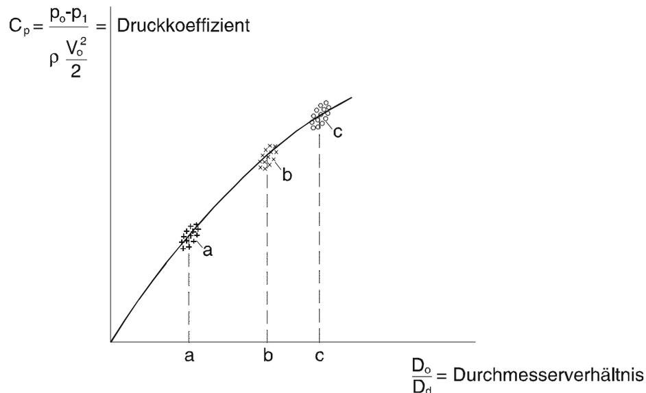
Abb. 6.3: Dimensionslose Darstellung des Druckkoeffizienten einer Meßdüse in Abhängigkeit vom Durchmesserverhältnis ("Eichkurve")
