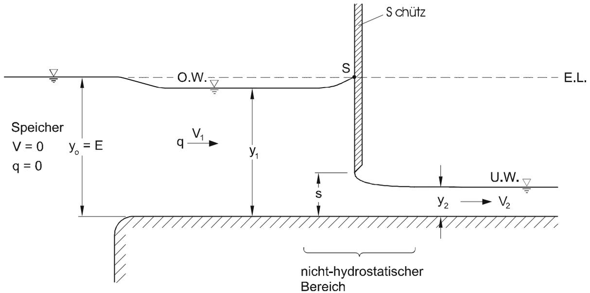
Abb. 10.12: Kanalströmung mit einem Schütz
