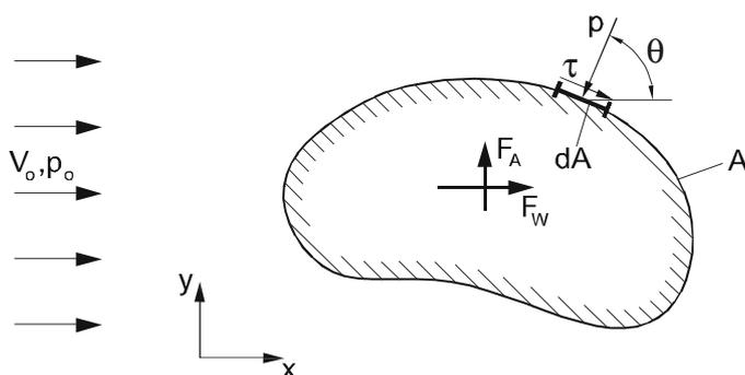
Abb. 9.1: Widerstand und Auftrieb bei Umströmung eines Körpers
