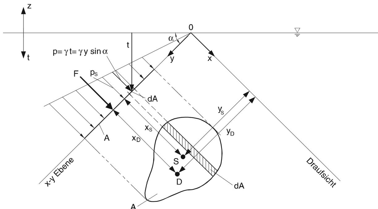
Abb. 2.12: Druckverteilung und resultierende Kraft F auf eine geneigte Fläche
