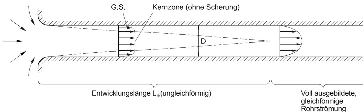
Abb. 8.10: Übergang von einem Behälter in eine Rohrleitung
