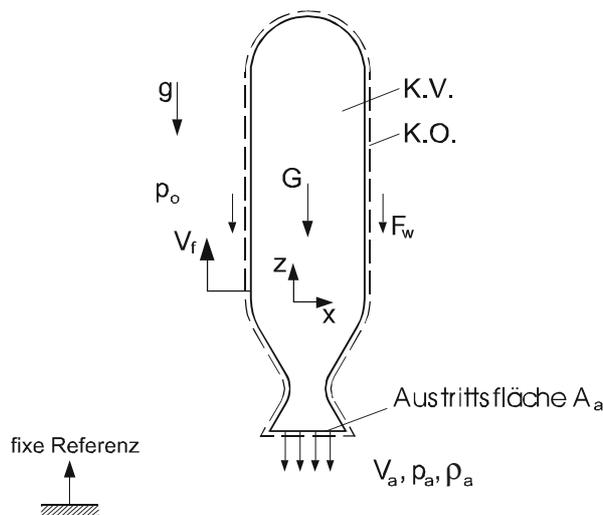
Abb. 4.27: Raketenflug mit beschleunigendem Kontrollvolumen
