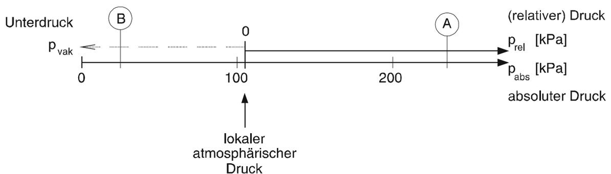
Abb. 2.5: Druckskala mit Definition des relativen, absoluten bzw. Unter-Druckes
