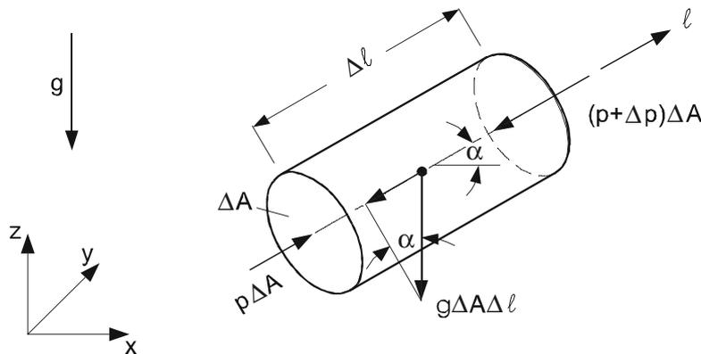
Abb. 2.3: Zylindrisches Element im Schwerfeld
