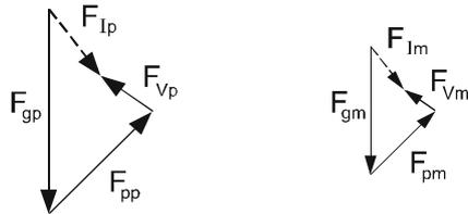
Abb. 6.6: Ähnliche Kräftepolygone im Prototyp und im Modell
