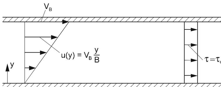
Abb. 7.2: Geschwindigkeits- und Schubspannungsverteilung bei laminarer Couette-Strömung
