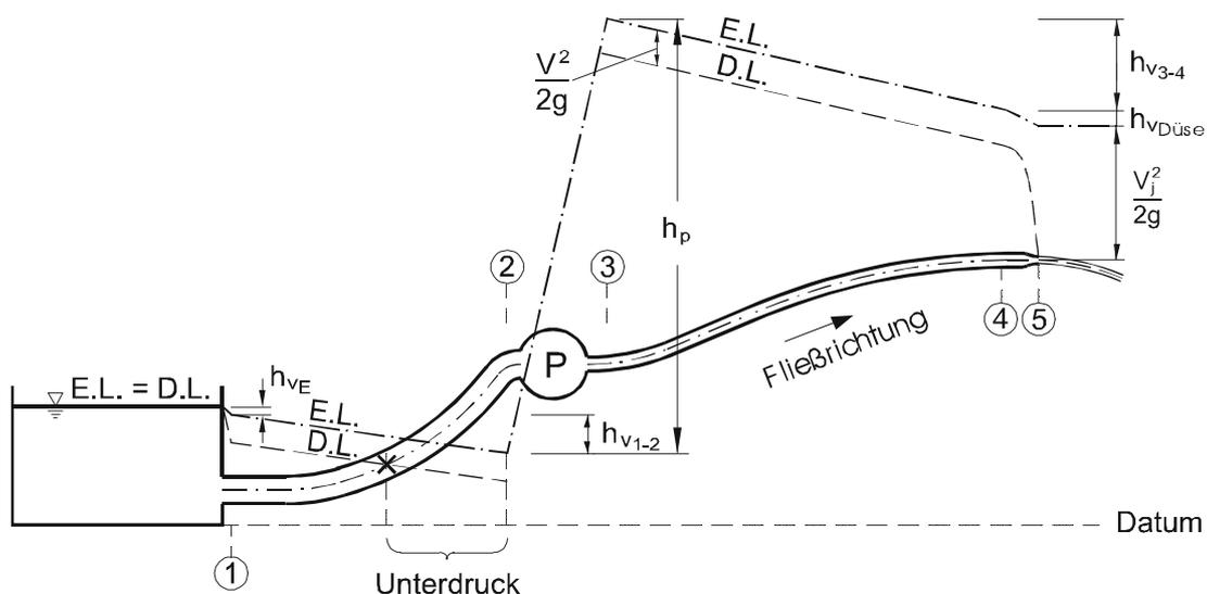
Abb. 5.4: Rohrleitungssystem mit Speicher, Pumpe, Düse und Freistrah
