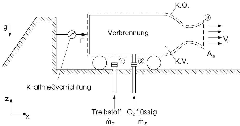
Abb. 4.21: Versuchstand für einen Raketenmotor
