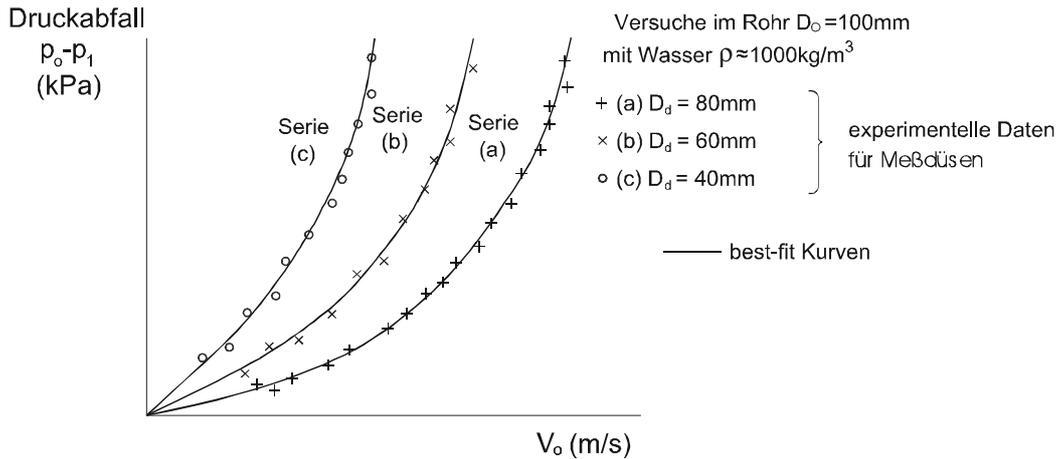
Abb. 6.2: Gemessener Druckabfall bei Meßdüse als Funktion der Geschwindigkeit
