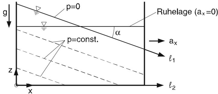
Abb. 4.2: Geneigter Wasserspiegel in einem Tank mit konstanter Querbewegung
