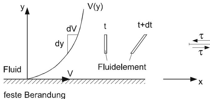
Abb. 1.3: Parallele Scherströmung
