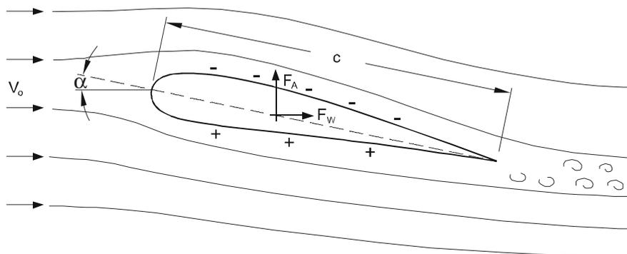
Abb. 9.10: Umströmung eines Tragflügels
