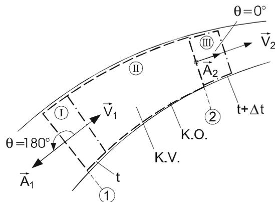
Abb. 3.16: Massensystem bei Durchströmung des Kontrollvolumens
