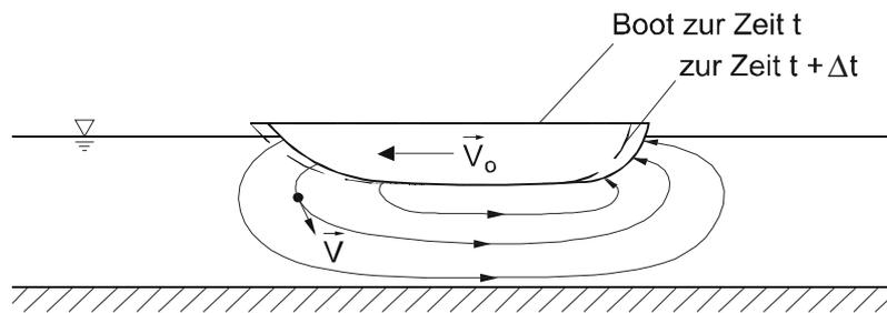
Abb. 3.6: Instationäres Stromlinienbild für Absolutbewegung: Beispiel eines Bootes in einem Kanal
