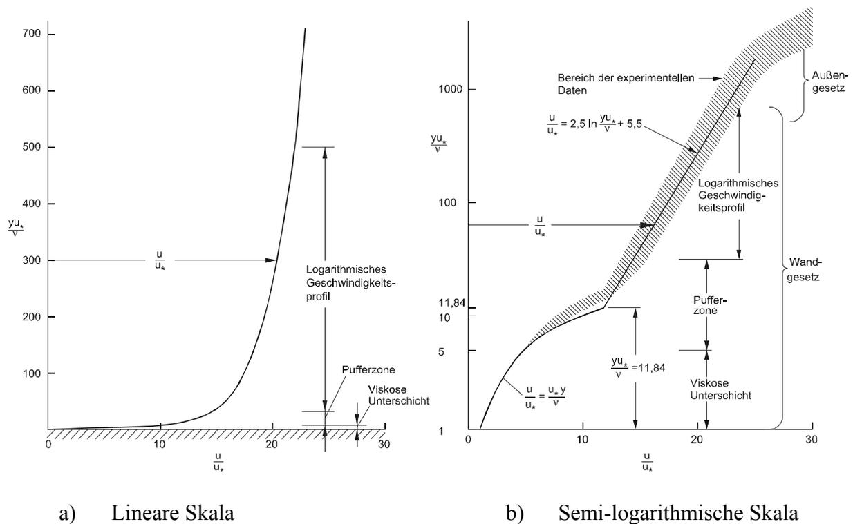
Abb. 7. 9: Geschwindigkeitsverteilung in turbulenter Grenzschicht entlang ebener glatter Platte (nach Roberson und Crowe, 1993)
