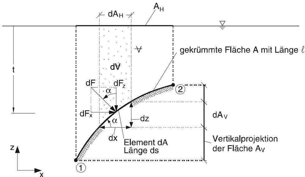
Abb. 2.14: Differentielle Kräfte auf gekrümmtes zweidimensionales Flächenelement  $dA$  (nach oben geneigt)
