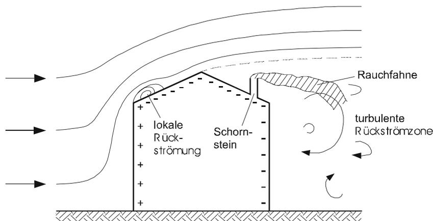
Abb. 9.14: Windanströmung eines Gebäudes
