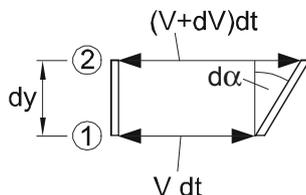
Abb. 1.4: Deformation eines vertikalen Fluidelementes in einer Schichtströmung
