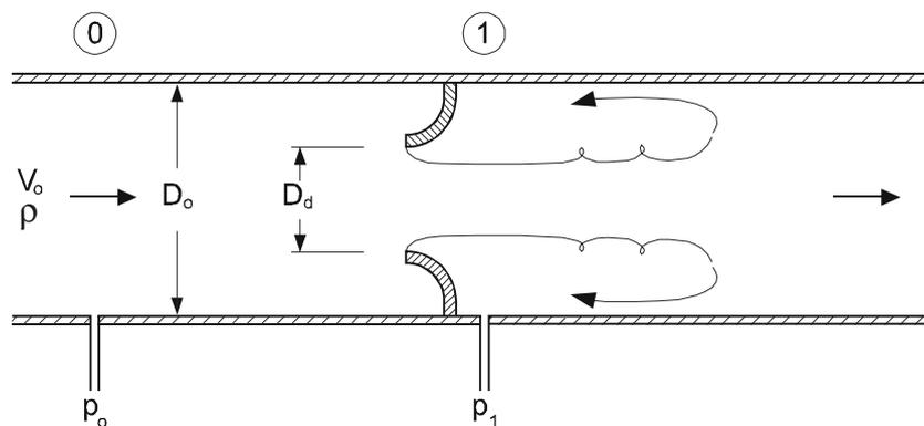
Abb. 6.1: Meßdüse zur Durchflußmessung in einer Rohrleitung
