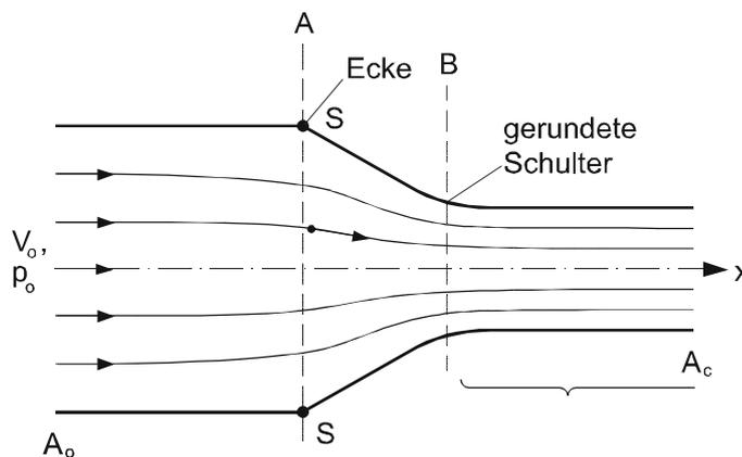
Abb. 4.10: Strömung in einer Verengung
