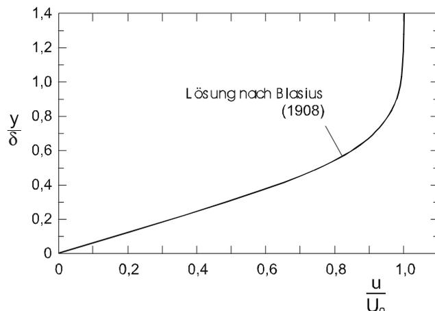
Abb. 7.6: Dimensionsloses Geschwindigkeitsprofil der laminaren Grenzschicht (nach Truckenbrodt, 1989)
