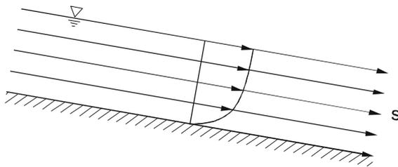
Abb. 3.5: Gleichförmige parallele Strömung: Beispiel einer Gerinneströmung mit freier Oberfläche
