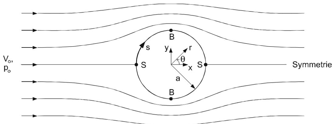
Abb. 4.13: Umströmung eines Kreiszyinders bei idealem Fluid
