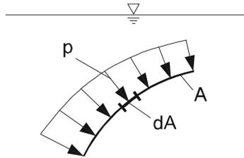
Abb. 2.13: Druckverteilung auf gekrümmte Flächen
