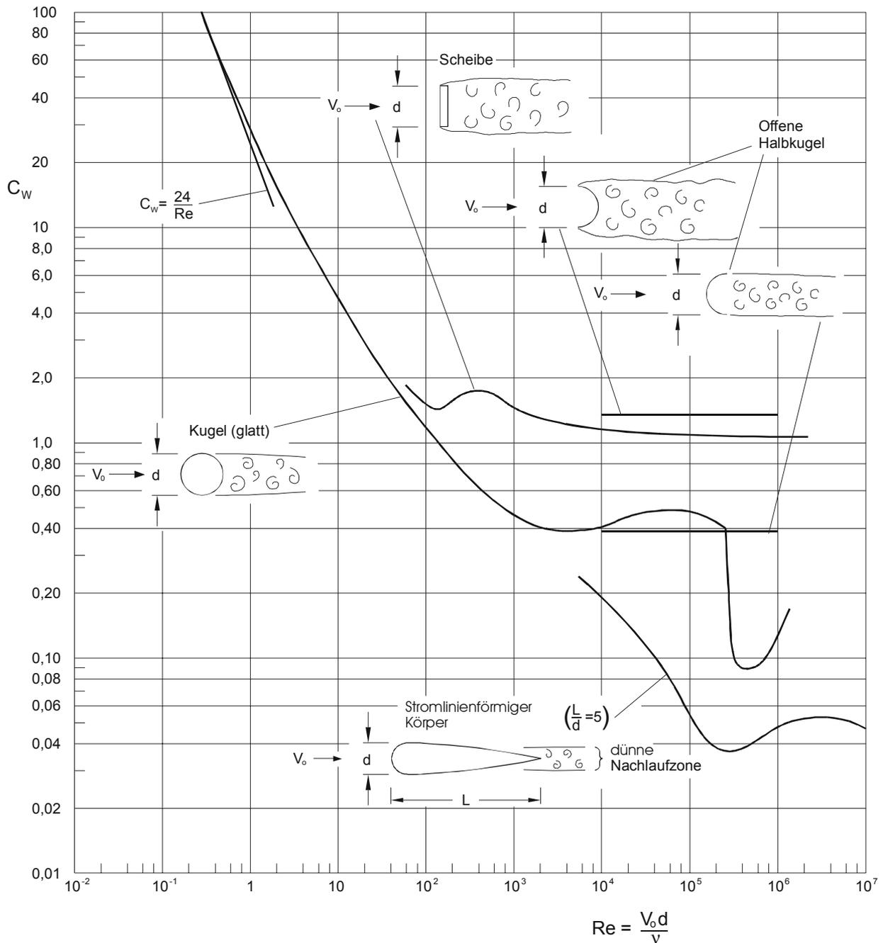
Abb. 9.9: Widerstandsbeiwerte  $C_w$  als Funktion der Reynoldszahl für dreidimensionale Körperformen (nach Roberson und Crowe, 1993)
