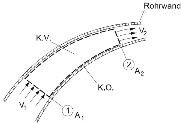
Abb. 3.15: Stromröhre als Kontrollvolumen im Falle einer Rohrströmung
