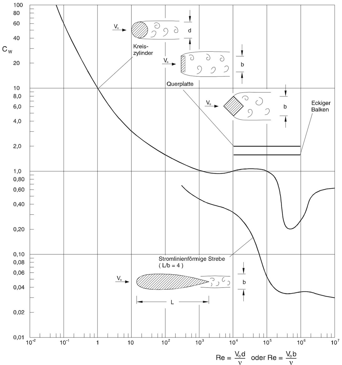
Abb. 9.8: Widerstandsbeiwerte  $C_w$  als Funktion der Reynoldszahl  $Re$  für zweidimensionale Körperformen (nach Roberson und Crowe, 1993)
