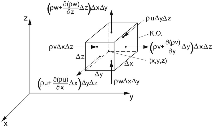
Abb. 3.17: Massenflüsse durch die Oberflächen eines elementaren Kontrollvolumens
