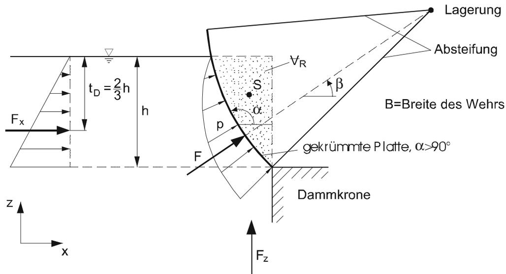
Abb. 2.16: Radialwehr mit Druckverteilung und Kraftkomponenten
