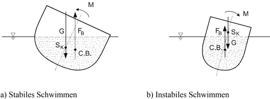
Abb. 2.21: Verhalten schwimmender Körper nach Auslenkung aus dem Gleichgewichtszustand
