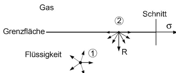
Abb. 1.9: Oberflächenspannung bei Übergang zwischen Flüssigkeit und Gas
