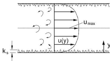
Abb. 8.6: Turbulente Strömung in einem Rohr mit Wandrauheiten
