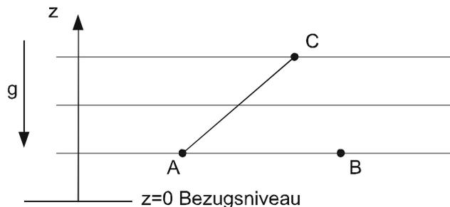
Abb. 2.4: Horizontale Niveaulinien gleichen Druckes
