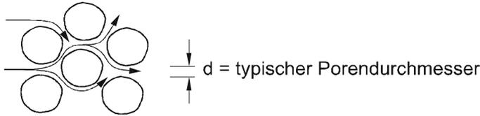
Abb. 4.31: Fließwege bei Grundwasserströmung durch die poröse Matrix
