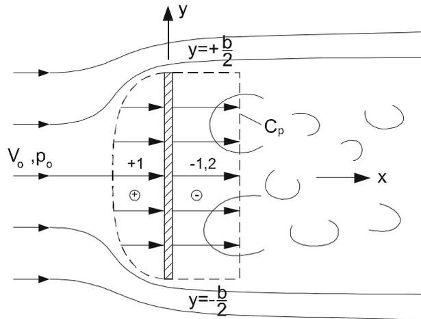
Abb. 9.5: Umströmung einer quergestellten Platte mit Ablösung an den Plattenkanten
