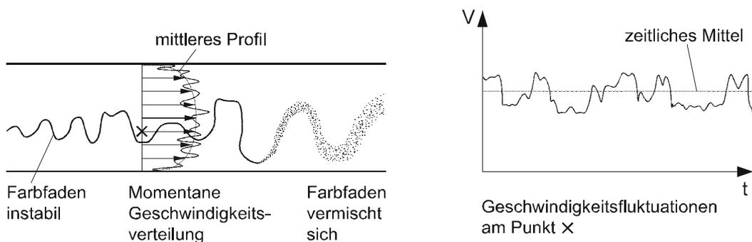
Abb. 3.10: Beobachtungen in einer turbulenten Rohrströmung
