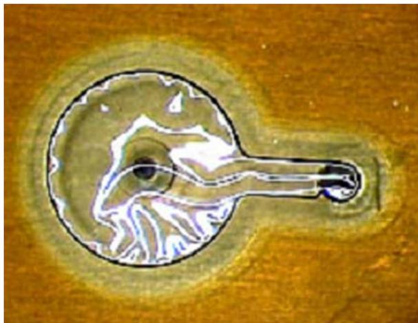
Abb.25 *Faltenwurf der Ventilmembran nach Verklebung mit Polypropylen*
