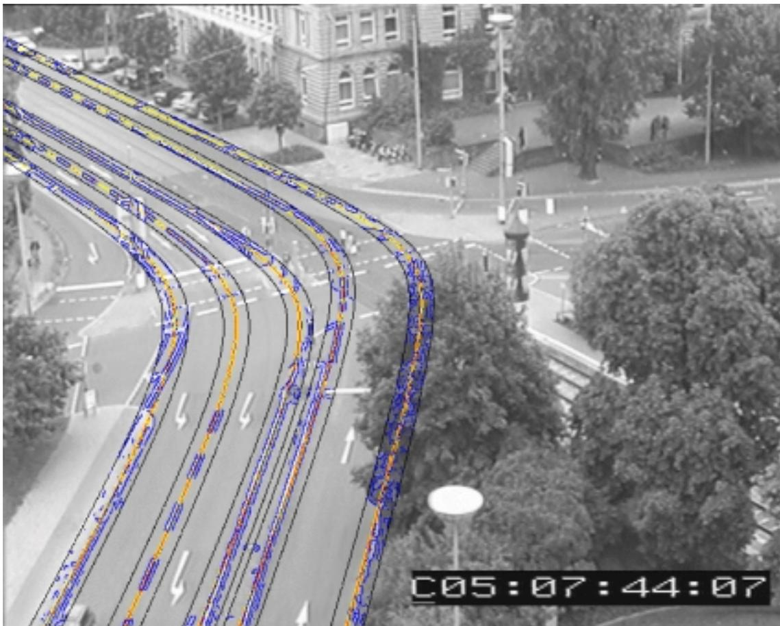
Abbildung 5.8: Dieses Bild zeigt das Ergebnis des Anpassprozesses, bei dem die in Abbildung 5.7 dargestellte Hyperbelbandschar an das Abbild eines Kreuzungsarmes der Bernhardus-Platz-Szene angepasst wurde. Beim Anpassprozess mittels Kantenelementanpassung wurden insgesamt 22 Parameter gleichzeitig geschätzt.
