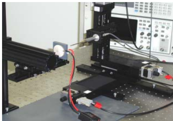
Abbildung 5.19: Aufbau zur Messung von Ultraschallfeldern
