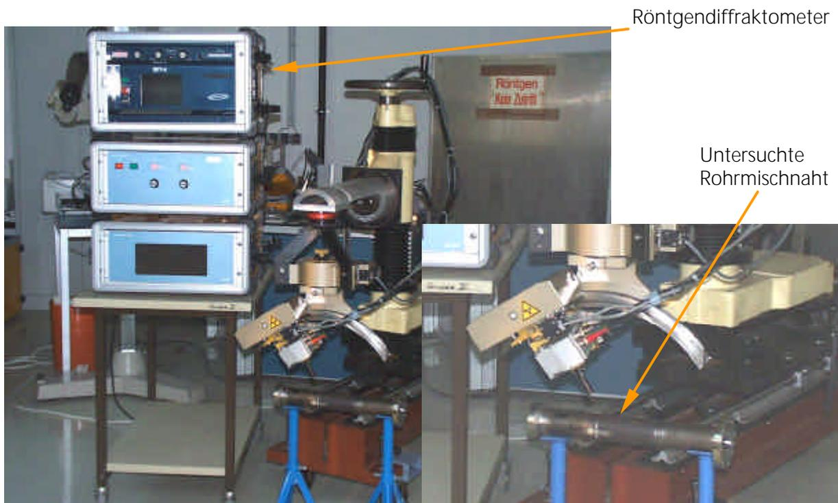
Bild 43 : Röntgenographische Eigenspannungsanalyse an Rohrmischnähten
