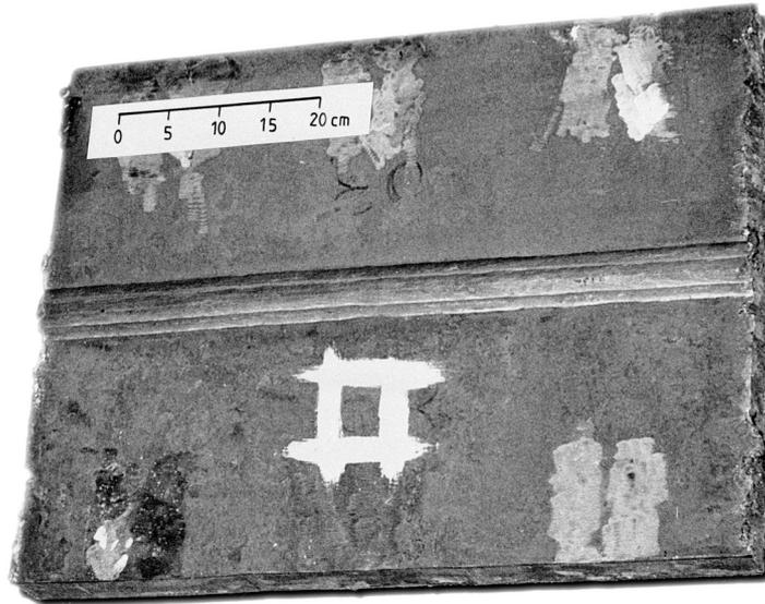
Bild 83 : Unterpulver- Verfahrensprüfschweißung (X-Naht,  $t = 70 \text{ mm}$ )
