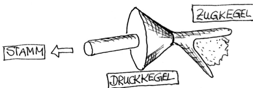
Abb. 8: Die Arbeitsteilung ist ideal: Stammseitig ist ein Druckkegel aus verdichteter und damit festerer Erde, während der stammferne Zugkegel aus zugfestem Wurzelholz gebildet wird. Bei Wurzelfäulen, die die Sinkerwurzeln zersetzen, verliert der Baum daher beides, Druck und Zugkegel. Resultat ist eine Wurzel ohne Knoten.
