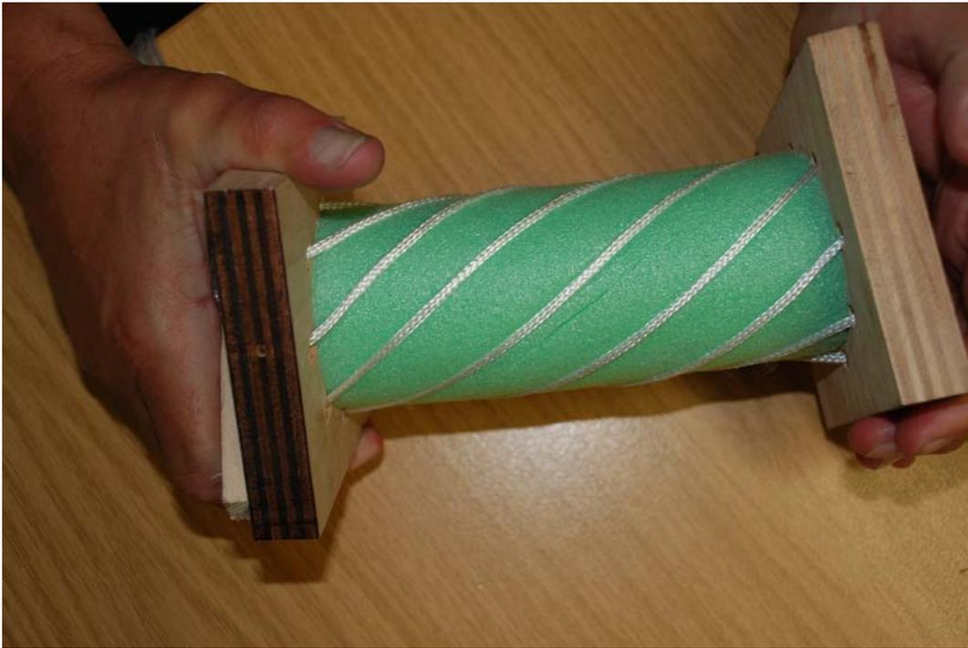
Abb. 5: Bei Torsion in Windungsrichtung schließt sich der Drehriss. Da allerdings drehwüchsige Bäume wegen des Risikos wechselnder Windrichtungen eine möglichst (!) symmetrische Krone haben sollten, scheidet diese Problemlösung meist aus.
