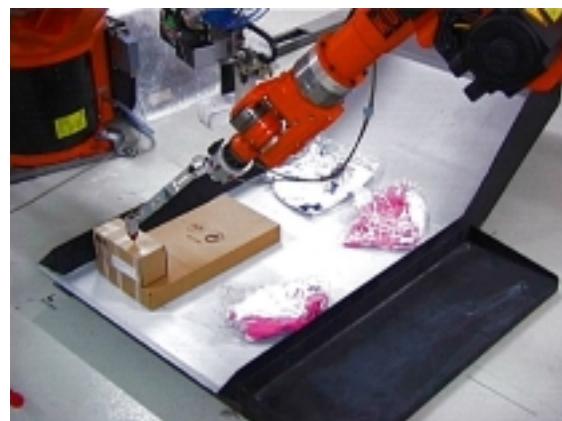
Abbildung 6.80: Das gegriffene Objekt konnte erfolgreich für die Entnahme angehoben werden.
