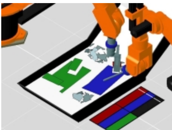
Abbildung 6.65: Der grüne Bereich ist durch sichtbaren Untergrund getrennt von den anderen Bereichen, so daß er nicht auf ungewolltes Mitanheben überwacht werden muß, obwohl er lose ist.
