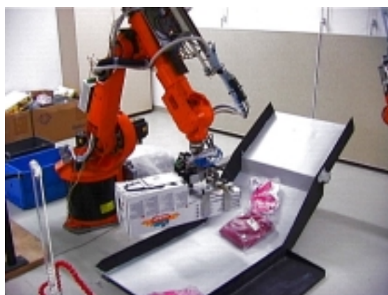
Abbildung 6.54: Der Roboter hat das Cluster zur Entnahme angehoben.
