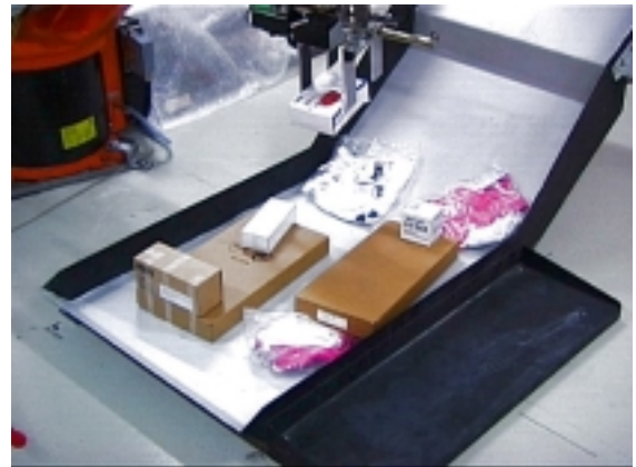
Abbildung 6.62: Der Roboter kann aufgrund der Begründung in Abschnitt 6.5.2 ohne Überwachung auf ungewolltes Mitanheben ein Objekt entnehmen.
