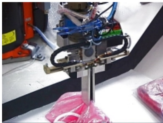
Abbildung 6.56: Der Greifer hat eine Weichware gegriffen und zur Entnahme angehoben.
