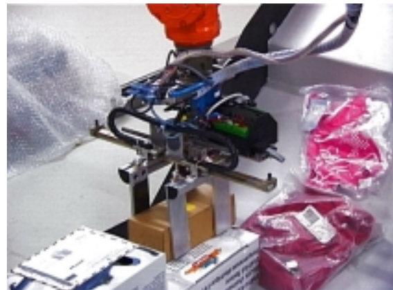
Abbildung 6.44: Der Roboter verdreht das zu einem anderen Szenenbereichshinweis gehörende Objektteil. Drehoperationen haben den Vorteil, daß sie die Objekte nicht weit deplazieren, so daß die Wahrscheinlichkeit des Herunterfallens von Objekten innerhalb der Szene während einer Untersuchungsoperation kleiner ist als bei Ausführung translatorischer Schiebeoperationen.
