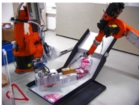
Abbildung 6.50: Mit einem taktilen Sensor wird das lose Cluster auf ungewolltes Mitanheben überwacht.
