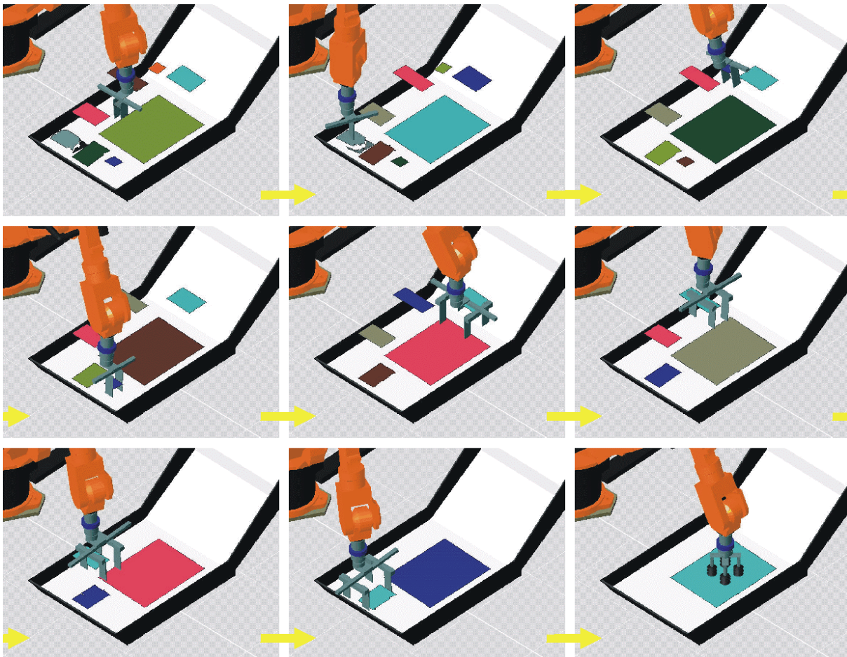
Abbildung 5.8: Optimierte Auswahl von Griffen und des Greifwerkzeugs beim Benchmark „Greiferwechsel“
