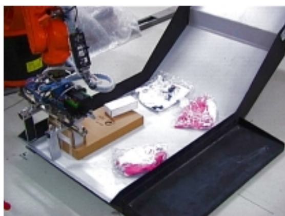
Abbildung 6.76: Ein Objektteil sollte verschoben werden. Die Operation mußte jedoch aufgrund des Feststellens einer Kollision mit der Peripherie abgebrochen werden.
