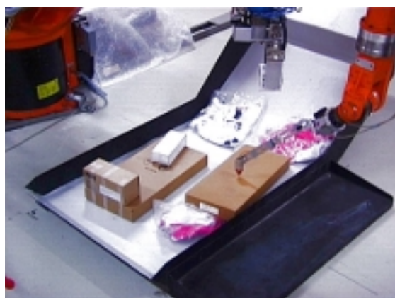
Abbildung 6.66: Der Roboter konnte erfolgreich ein Objekt für die Entnahme anheben.
