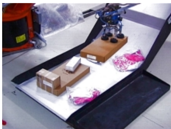
Abbildung 6.68: Es war kein numerischer Griff vorhanden für den Backengreifer, so daß ein Greiferwechsel erforderlich war.
