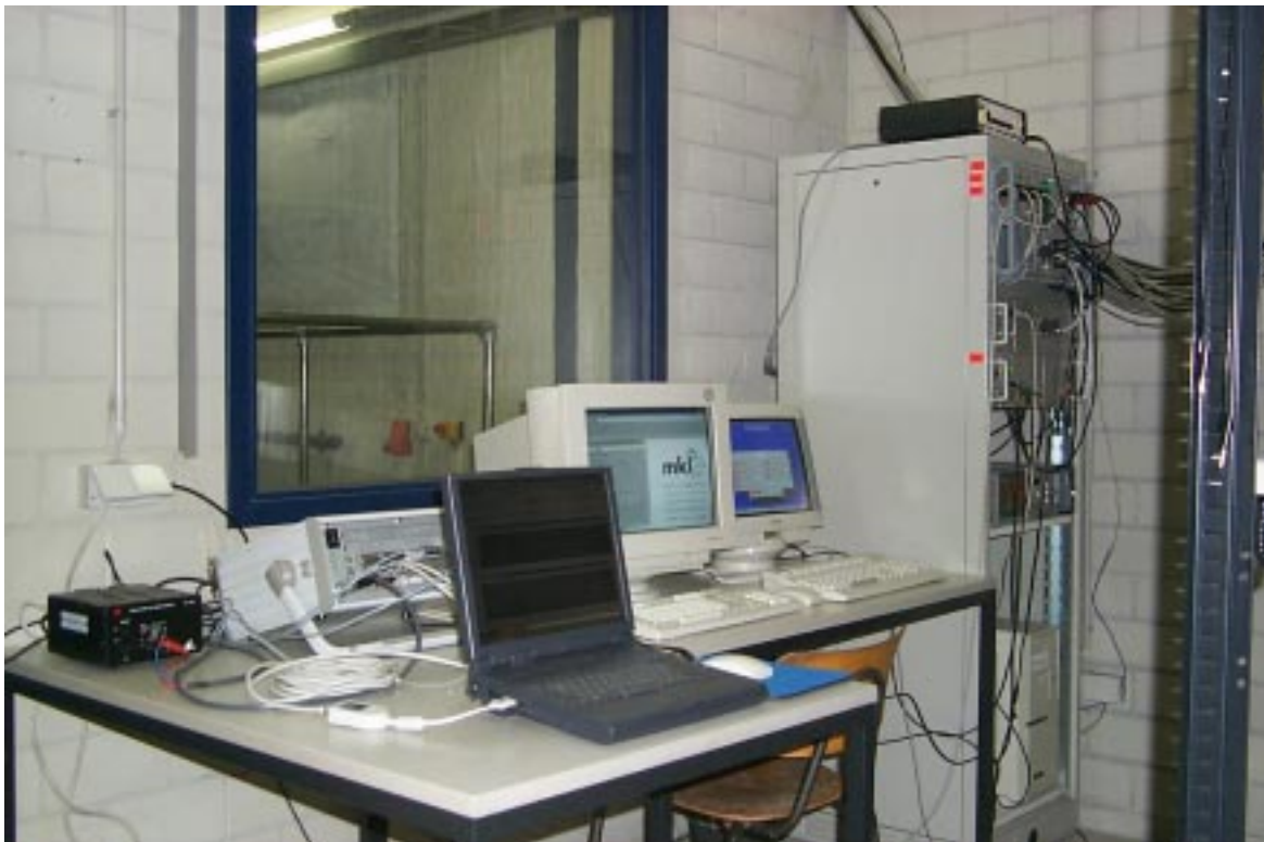
Bild 5: Meßwarte des Antriebsbaugruppenprüfstands
