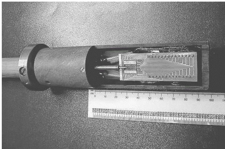
**Abb. 4.1.** Probenhalter. Auf dem Substrat befinden sich vier YBCO/STO/Au-Strukturen, deren Kontaktierung zum Chipträger durch Ultraschallbonden mit 25µm dickem Aluminiumdraht erfolgt.
