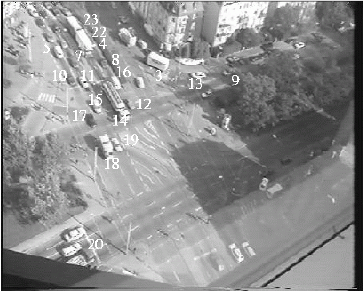
Abbildung A.13: Erstes Einzelbild einer Bildfolge, die am Nibelungenplatz in Frankfurt aufgezeichnet wurde. Zu jedem verfolgten Fahrzeug ist die systemintern vergebene Objekt Nummer angegeben. Zur Beibehaltung der Übersichtlichkeit wurden die berechneten Trajektorien nicht eingezeichnet.
