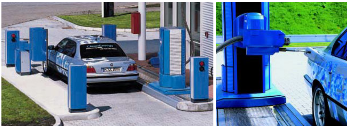
Bild 2.3: Automatisierte Betankungsanlage (li.) mit Betankungsroboter (re.) für Flüssigwasserstoff
