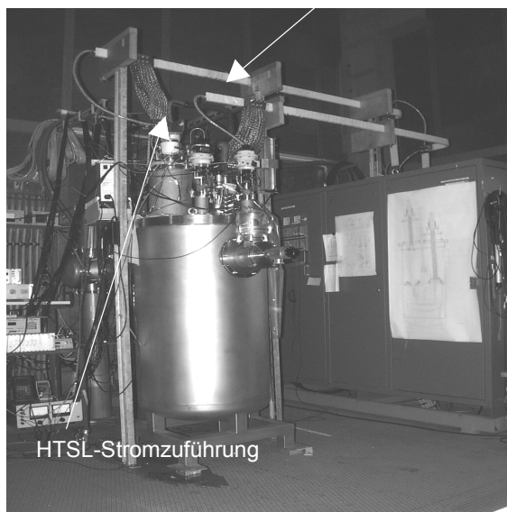
Abb. 5.6 Links: Aufnahme des Kryostats mit der HTSL-SZF und der konventionellen SZF. Rechts: Schema der zwei SZF mit dem NbTi-Kurzschlussbügel und des Kühlsystems.
