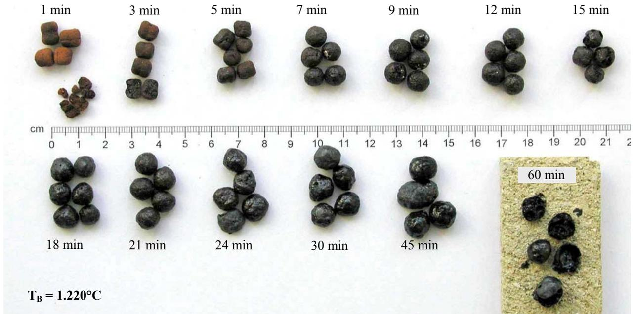
Bild 3-4: Auswirkung der Brennzeit
