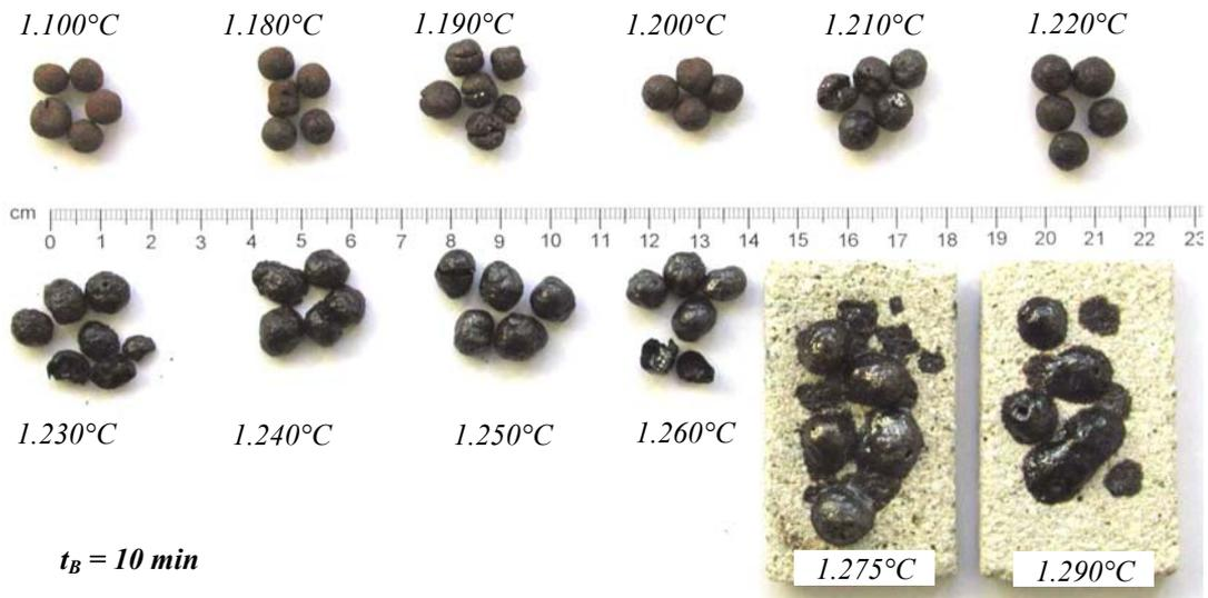
Bild 3-3: Auswirkung der Brenntemperatur
