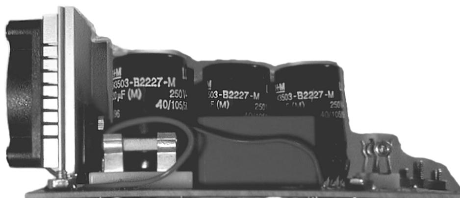
**Abbildung 112: Bild der Hochleistungstreiberstufe**
