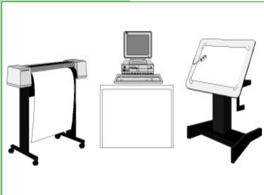
Elemente eines CAD-Arbeitsplatzes
