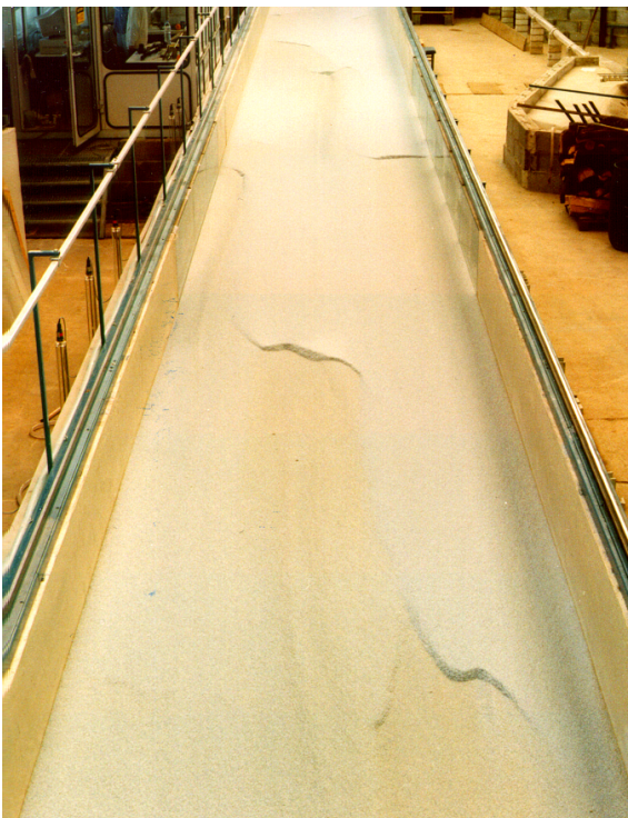
Abb. III-5.65 Beobachtete Bettformation sechs Monate nach Hochwasser 1989 bei Wasserführungen unter 400 \text{ m}^3/\text{s} (Transportkörper bei Niedrigwasser).
