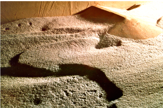
Abb. III-5.84 Sohlformen (Längsdünen) im Buhnenfeld.
