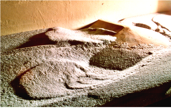
Abb. III-5.83 Ausgeprägte Kolkbildung am Buhnenkopf.
