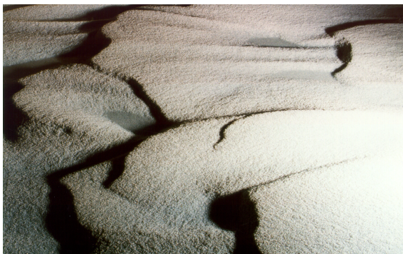
Abb. III-5.44 Beobachtete dreidimensionale Dünenformen in der großen Laborrinne.
