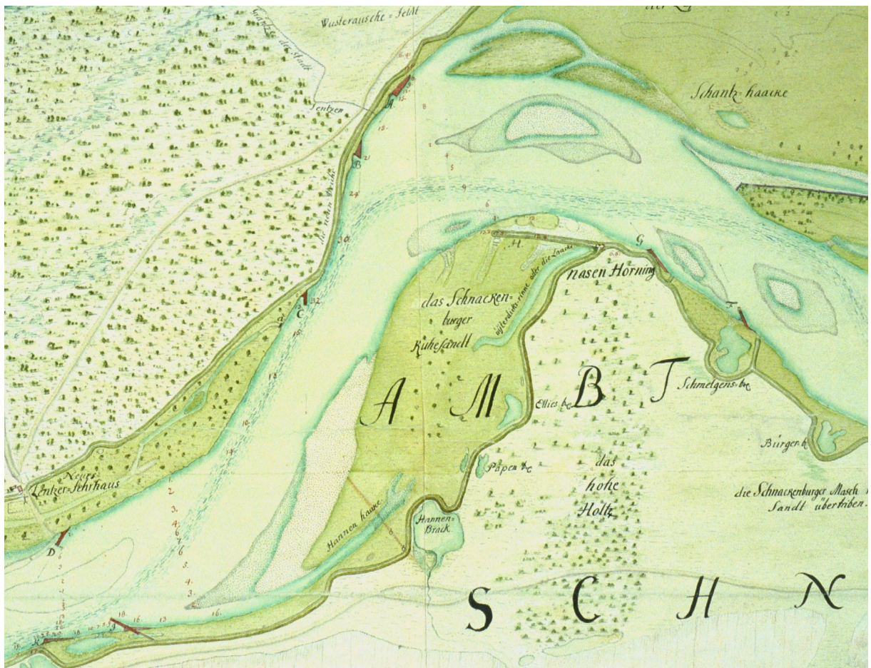
Abb. II-2.3 „General Carte von dem Elbe-Strohm“ 1724 (Kartenquelle: Niedersächs. Hauptstaatsarchiv Hannover), siehe auch Anlagen-CD oben: Gesamtübersicht der Karte, zusammengesetzt aus zwei Teilansichten (entzerrte und georeferenzierte Fotos im GIS) unten: Detailansicht mit Deichen, morphologischen Strukturen (Inseln, Bänke, Rinnen etc.), Wassertiefen (in preuß. Fuß), Ufersicherungen (vereinzelte Einbauten), Nutzungen („Feldt, Holtz“), Gemarkungen („Gräntze der Stadt Lentzen“), etc.
