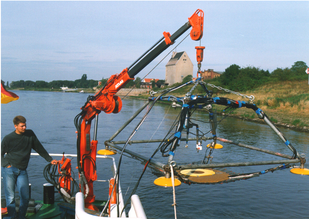
Abb. III-4.1 Einsatz der Schubspannungsmesseinrichtung bei Wittenberg.
