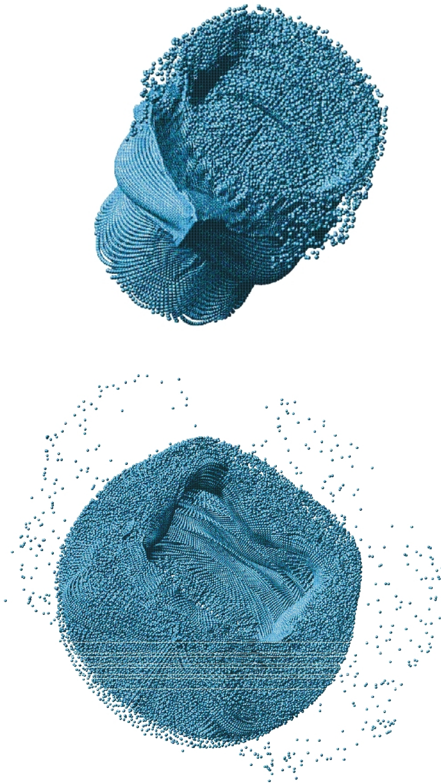
Bild 5.30: Verformung der grob diskretisierten SPH-Platte S3 nach a) 5 ms und b) 15 ms
