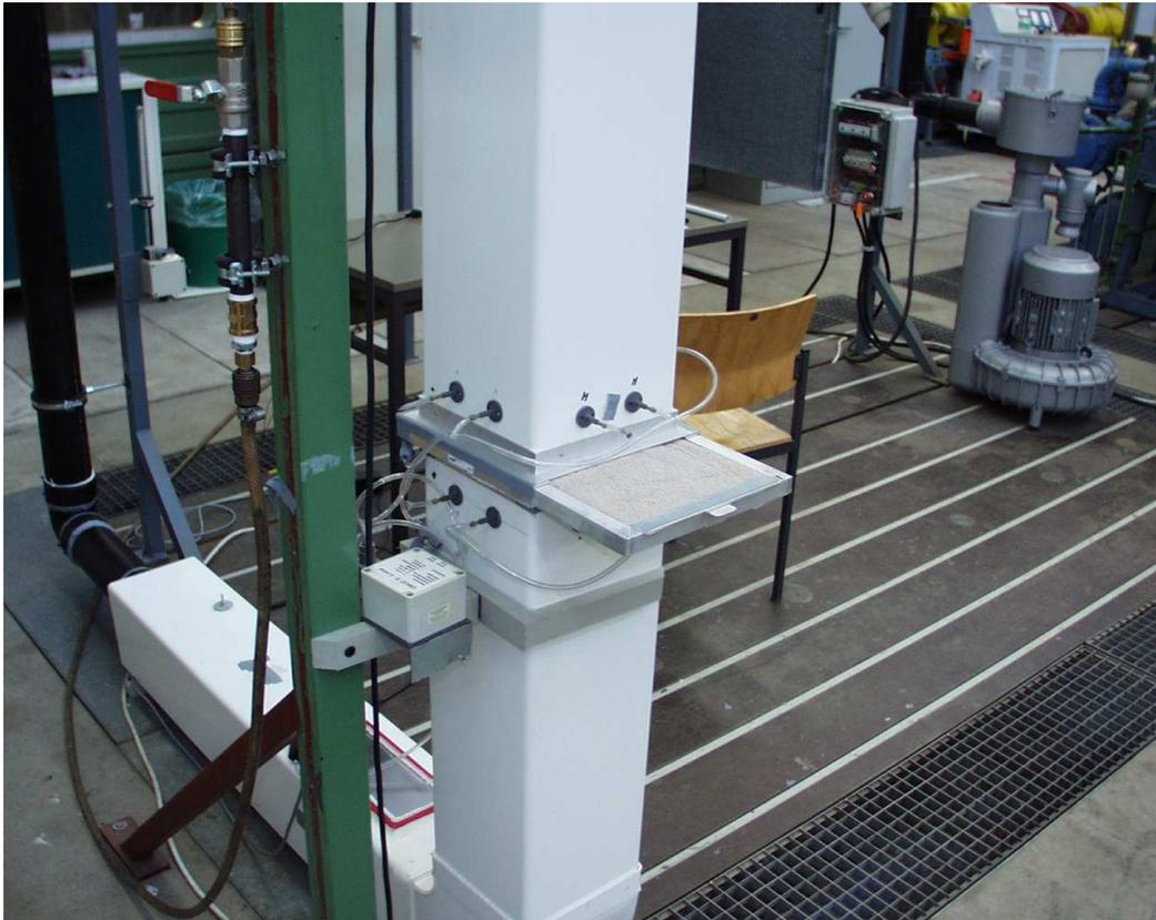
Abbildung 4.5: Filter in Wechsellvorrichtung
