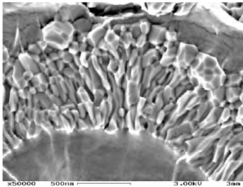
Abb. 5.22: Kornstruktur des NS10000 nach der Reaktion 650 °C/200 h
