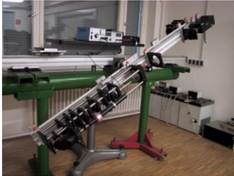
Abbildung 4.11: Interferometer auf optischer Bank
