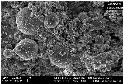
Abb. 4-71: Steinkohlenflugasche Steament nach Reaktion mit Wasser (2.200-fache Vergr.)
