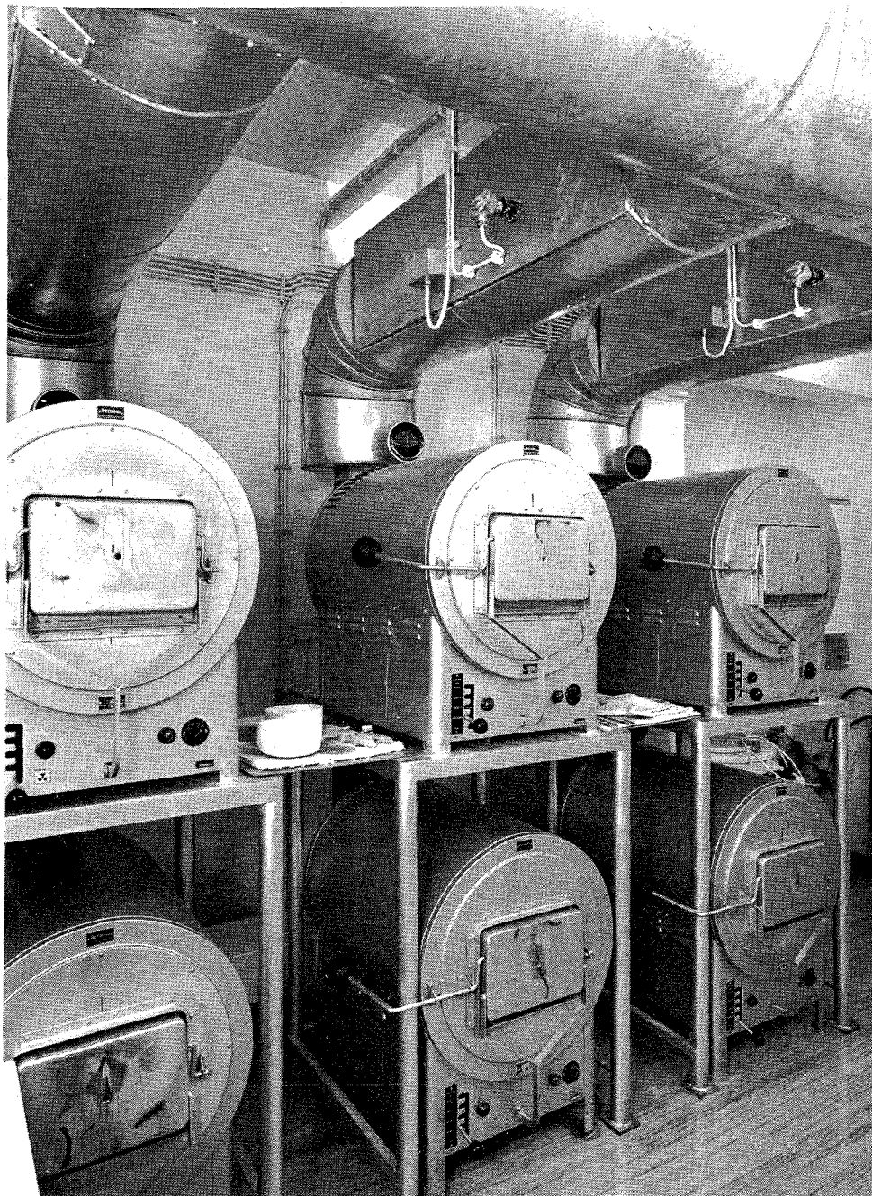
Abb. 21 Veraschungsöfen mit katalytischer Nachverbrennung der Schwelgase
