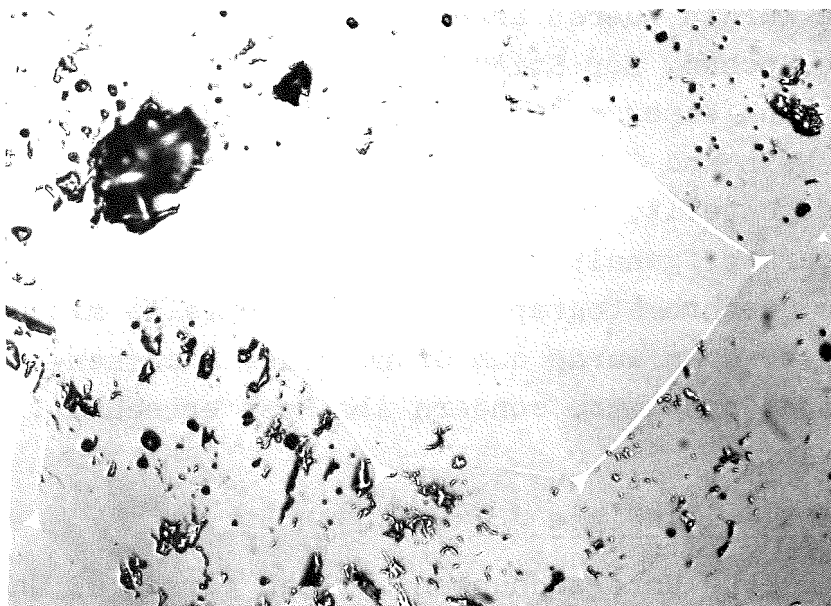
Bild 7: Ungeätztes Gefüge von UN-Pellets mit Grobkornbildung durch metallisches Uran (helle Phase an Korngrenze) 500-fach vergrößert
