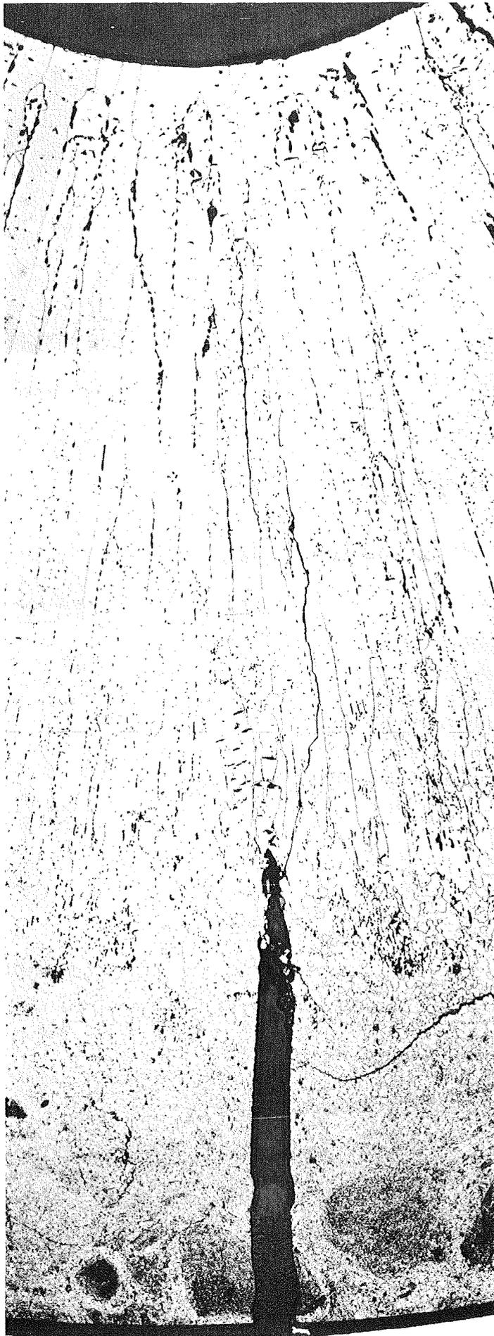
Abb. 13 Transport von Risfvolumen durch Bildung von Linsenporen
