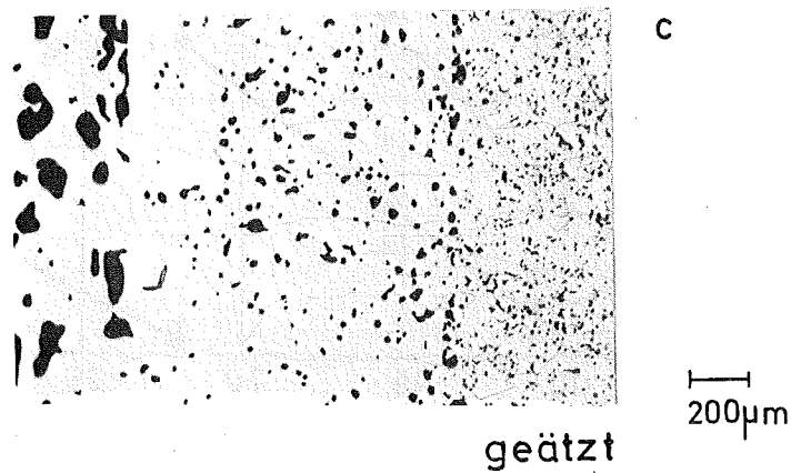
Abb. 59: Typische Diffusionszonen im System Fe + 6 % Si(Si 3 N 4 ); Ätzung: 1 % alkoholische HNO 3
