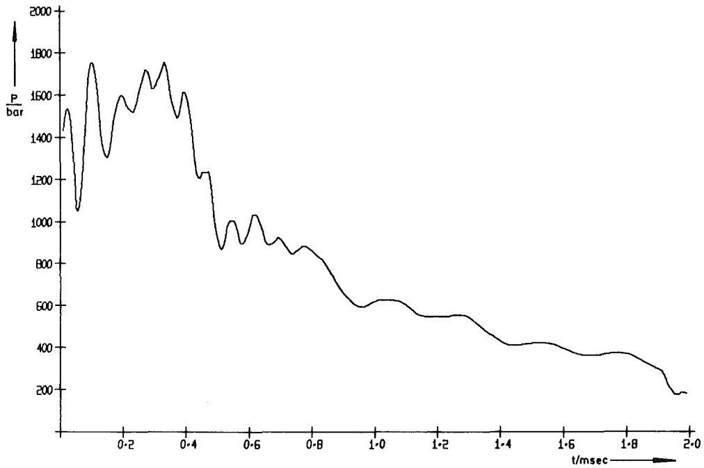
Abb.6: Druck-Zeit-Verlauf im FFTF-Fall mit 0.2 msec Mischungszeit (5 Sektionen)
