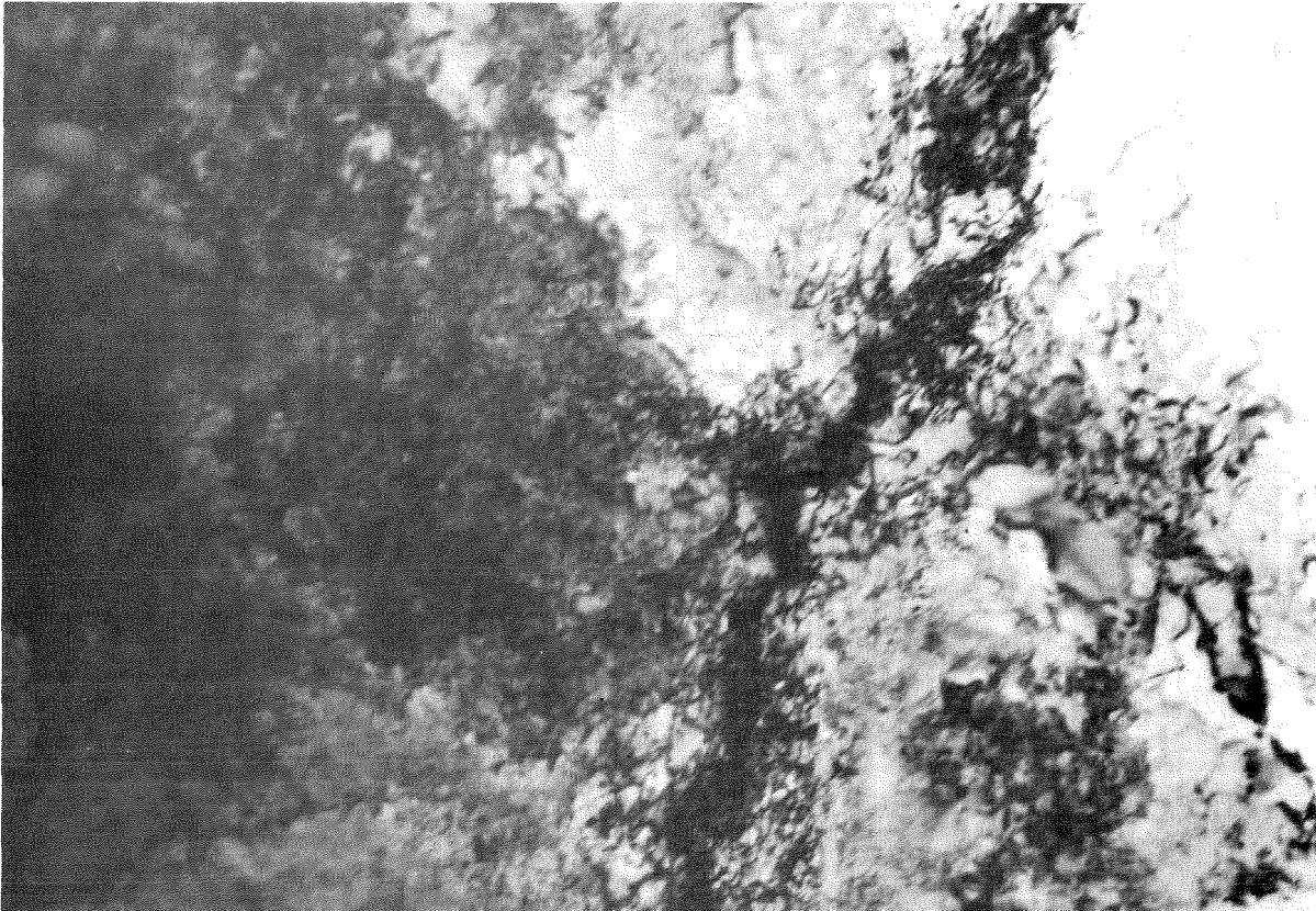
Versetzungsstruktur der Nb33 at % Ta3 Probe × 120 000
