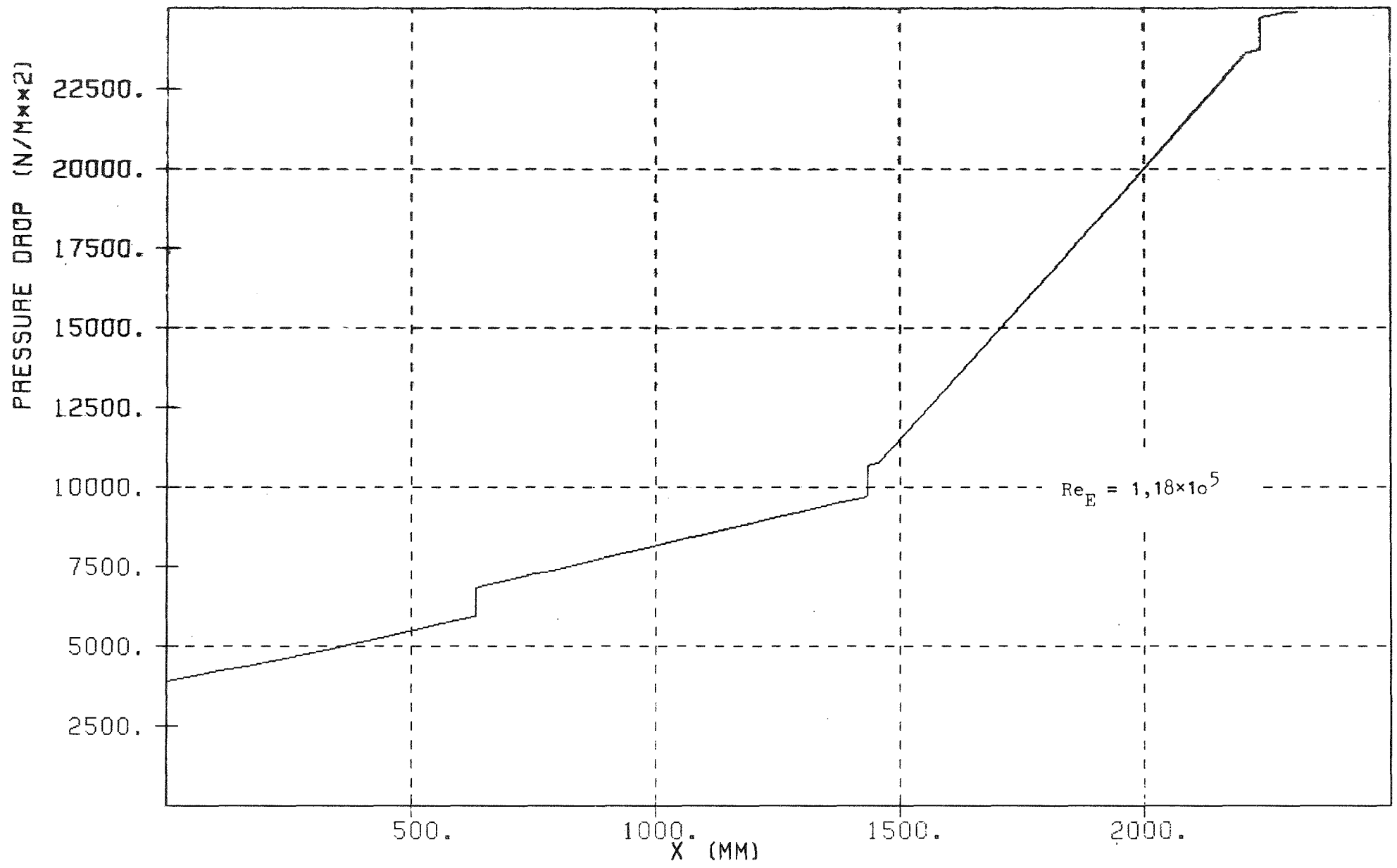
Abb. 19 Vergleich zwischen Rechnung und Messung: Druckverlust im 19-Stabbündel bei turbulenter Strömung (Test 1o thermisch)
