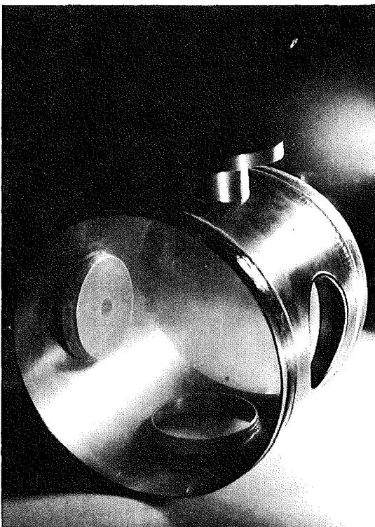
Abb. 14: Heliumtarget a) Titanvakuumtank
