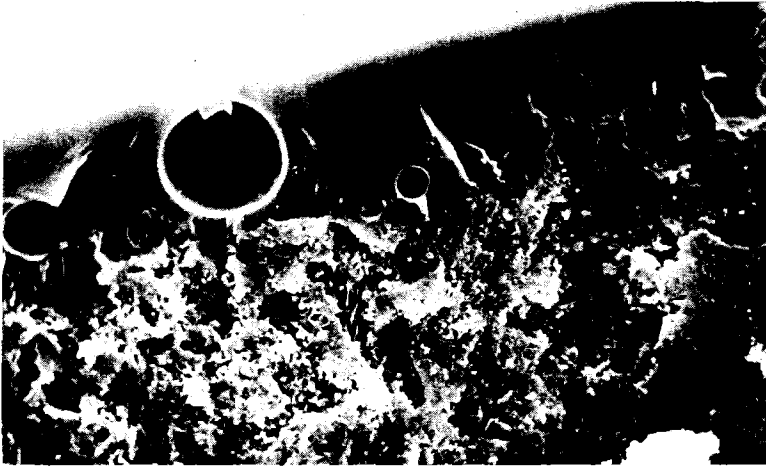
Bild 60: Material 3 Schockglühung (1375°C, 10 min), Bruchfläche REM-Aufnahme 1180:1
