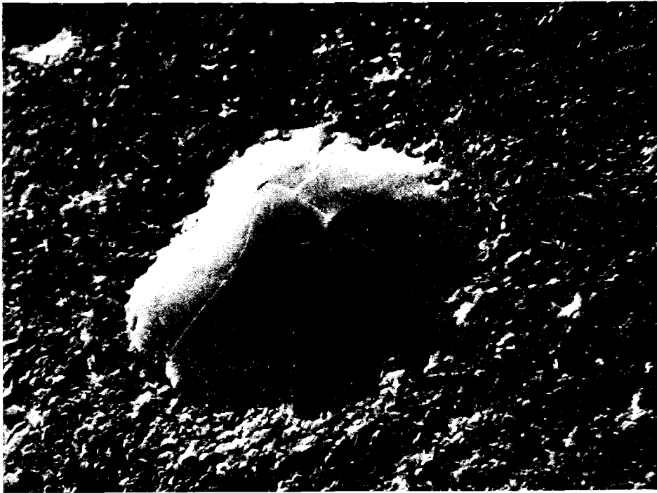
Bild 65: Oberfläche einer Kriechprobe (1450-1475°C, 106 h) REM-Aufnahme 220:1
