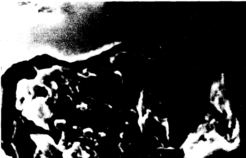
Bild 68: Anschlag einer Kriechprobe (Material 3) REM-Aufnahme 22000:1
