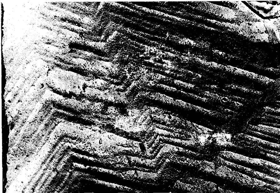
Abb. A4b: 15 000-fach; 1\text{cm} \hat{=} 670\text{nm} deutlich sichtbare Cu-Kristallite von ca. 30 nm Größe beim Cu-Matrizenabdruck von der \text{CuSn} -Matrix
