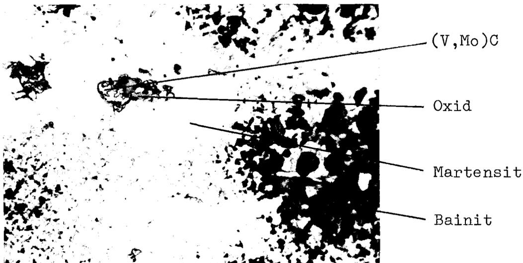
Abb. 50: Gefüge der Legierung 2 % MVM, 0.6 % C<sub>ges</sub> SST
