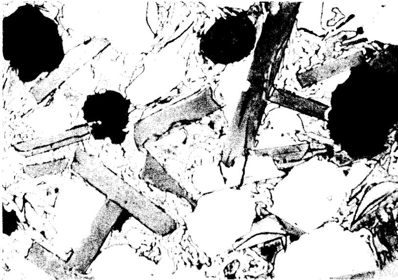
Abb. 16: MVM, elektrolytisch geätzt mit verdünntem Ammoniak, anschließend 2 % Nital  $V = 500 \times$
