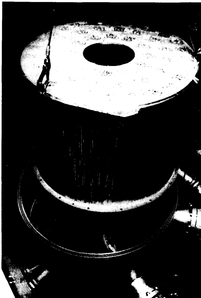
Abb.25: Einsetzen des Trennelementkorbes in eine Trenndüsenstufe.
