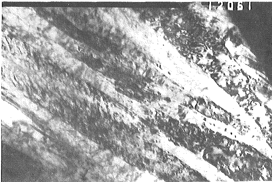
Abb. 30: Bindephase eines WC-20 Gew % (72,1 Fe-10,7 Co-17,2 Ni-4,8 Mo 2 C-2 Cr 3 C 2 ) Hartmetalls. DFZZ 0,8. TEM Aufnahme. 60 000 x 1,5
