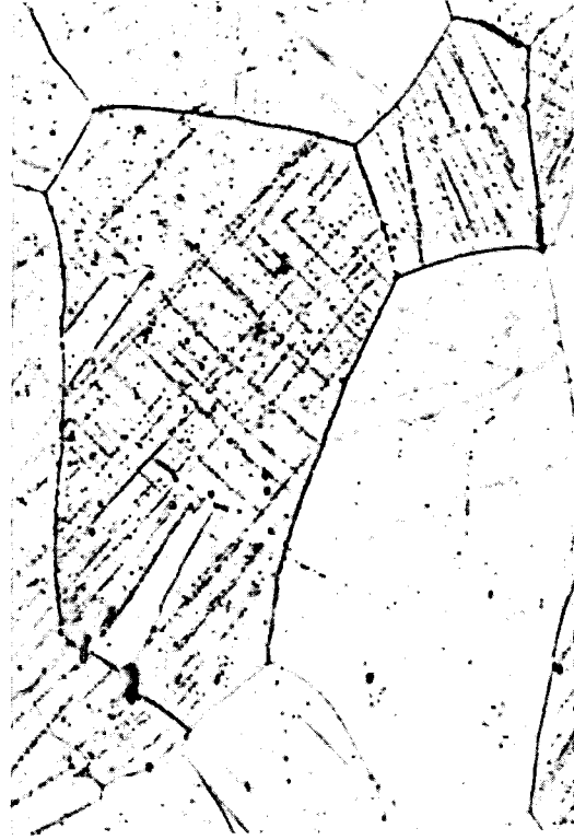
Abb. 43: Gefüge nach 15%kv+973K-1000 Std., V2A-Beize, 1000X
