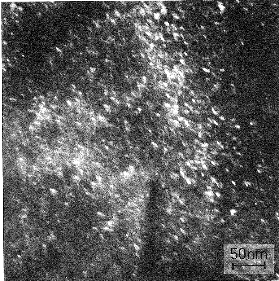
Abb. 21: \omega -Phase in NbTi65
