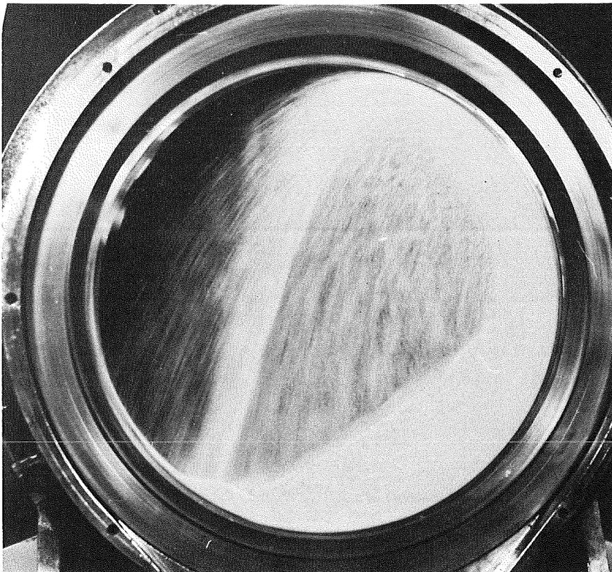
Abb. 84: Radiale Füllungsbewegung der Fraktion 250/315  $\mu\text{m}$
