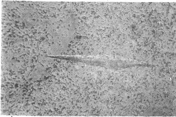
Bild 20 b und c: Größe und Form eines Risses durch einen Knoop-Härteeindruck (HK 7000)
