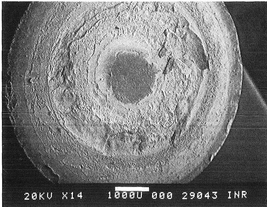
Abb. 16-2 Verformung der Stirnfläche nach einem Versuch bei H. T.
